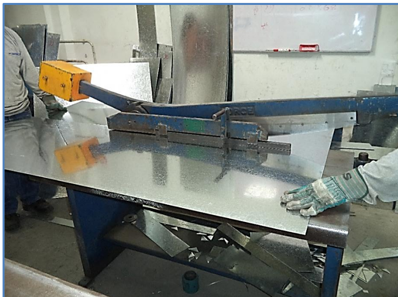
Figura 42: Corte de planchas de 1.5mm de espesor Fuente: Elaboración Propia – BRANCH S.A.C
