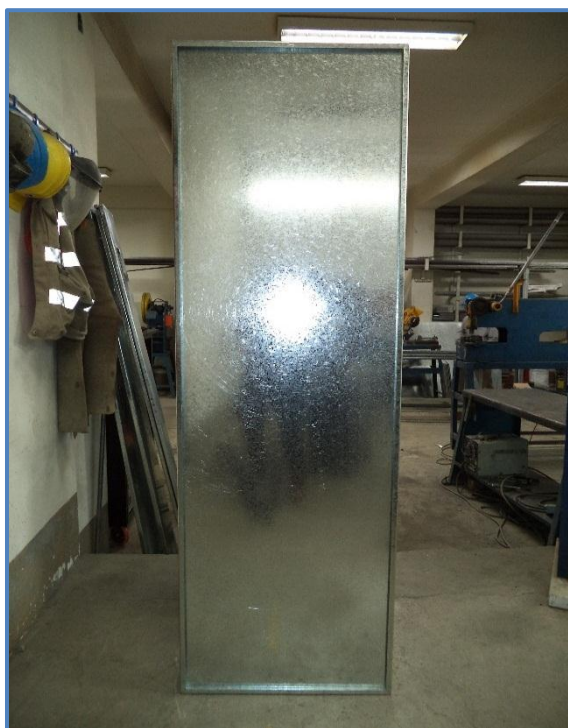
Figura 45: Tapa lateral de un tablero autoportado Fuente: Elaboración Propia – BRANCH S.A.C
