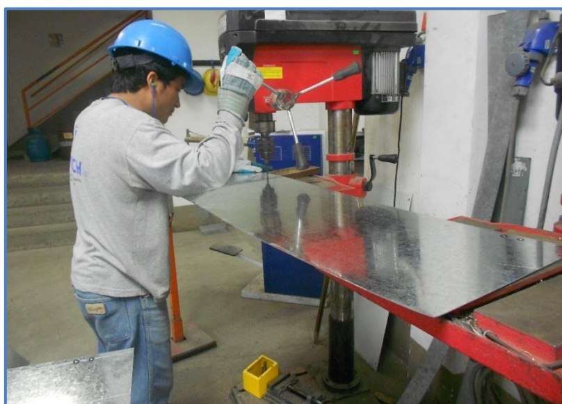
Figura 43: Calado de una puerta para un tablero eléctrico Fuente: Elaboración Propia – BRANCH S.A.C
