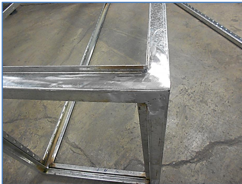
Figura 38: Vista del tablero eléctrico después de haber sido esmerilado. Fuente: Elaboración Propia – BRANCH S.A.C
