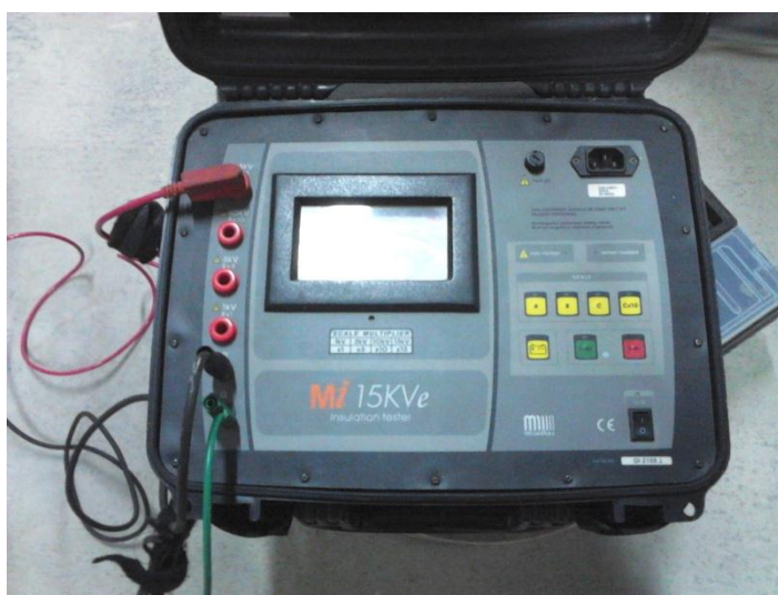
Figura 56: Megohmetro Analógico MI 15KVe – Megabras Fuente: Elaboración Propia – BRANCH S.A.C
