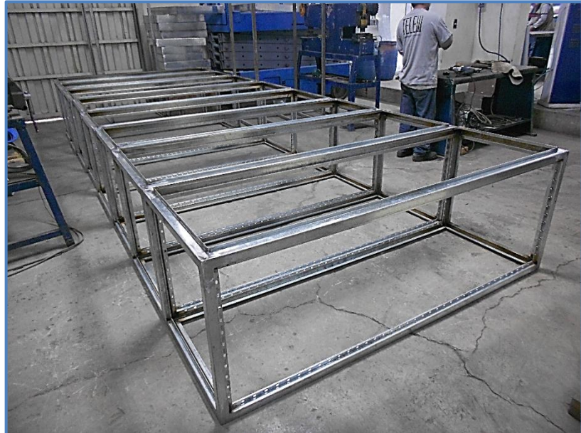
Figura 40: Perfiles estructurales de siete tableros eléctricos autoportados Fuente: Elaboración Propia – BRANCH S.A.C
