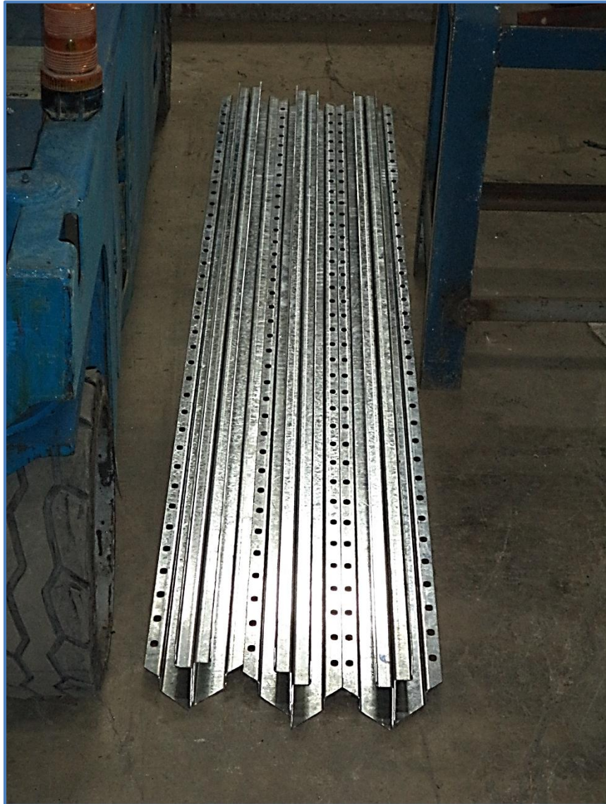
Figura 33: Perfiles de columna de fondo, longitud 2000 mm Fuente: Elaboración Propia – BRANCH S.A.C
