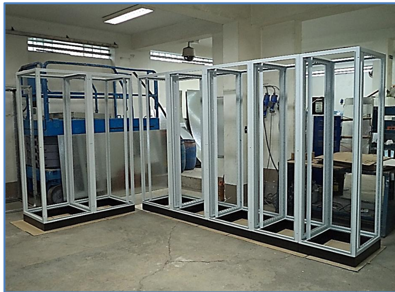
Figura 50: Estructura de tableros en el área de ensamble. Fuente: Elaboración Propia – BRANCH S.A.C
