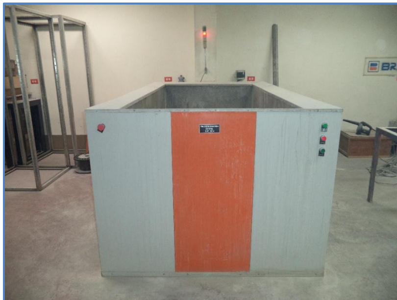
Figura 46: Tanque de lavado de superficies estructurales. Fuente: Elaboración Propia – BRANCH S.A.C
