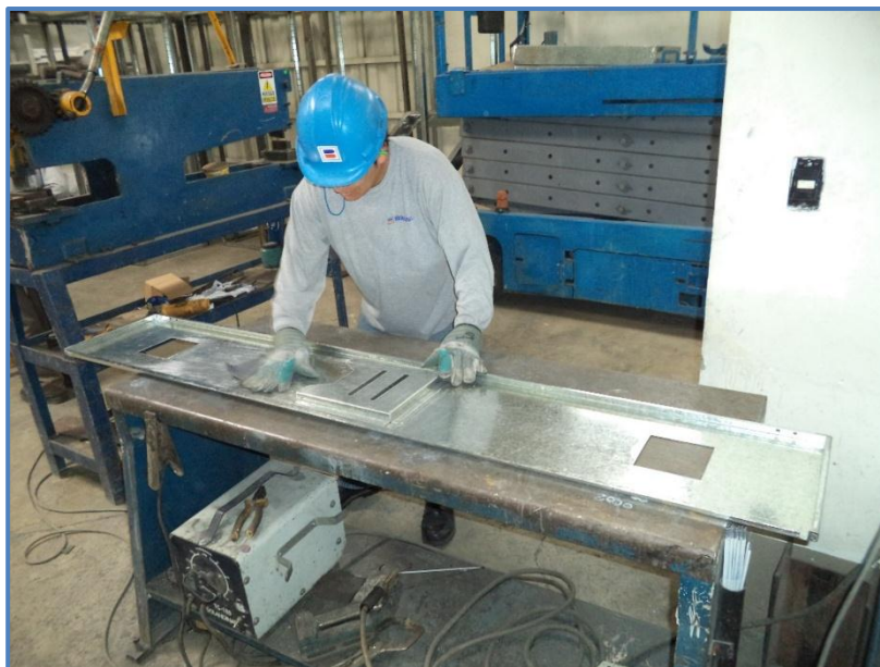
Figura 44: Mitad de una puerta de doble hoja de un tablero autoportado Fuente: Elaboración Propia – BRANCH S.A.C
