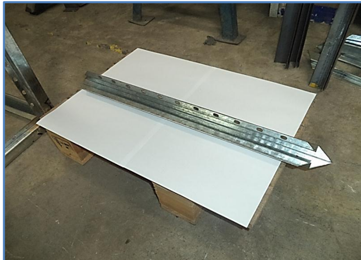
Figura 31: Perfil de Base Lateral de longitud 700 mm – Vista Isométrica Fuente: Elaboración Propia – BRANCH S.A.C
