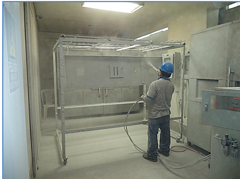
Figura 47: Aplicado de pintura electrostática color Ral 7035 Fuente: Elaboración Propia – BRANCH S.A.C
