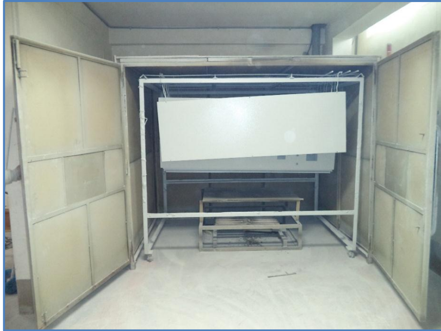
gura 48: Horno a gas por convección forzada. Fuente: Elaboración Propia – BRANCH S.A.C
