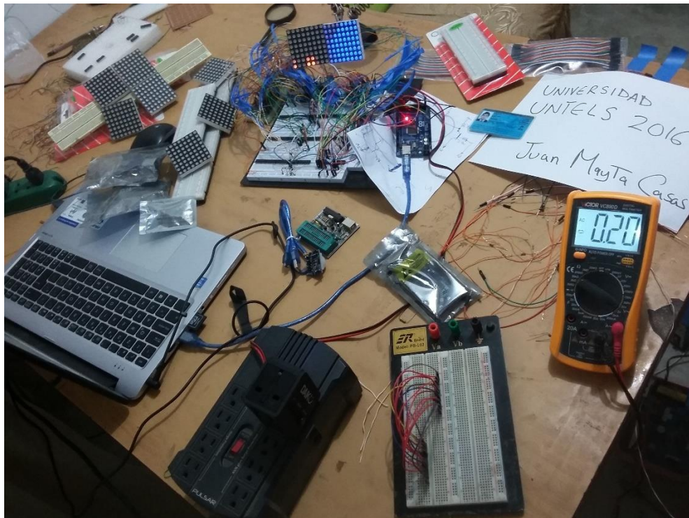
FIGURA 3.37: Pruebas iniciales en el prototipo de panel LED RGB con 2 matrices 8x8 ensambladas.
