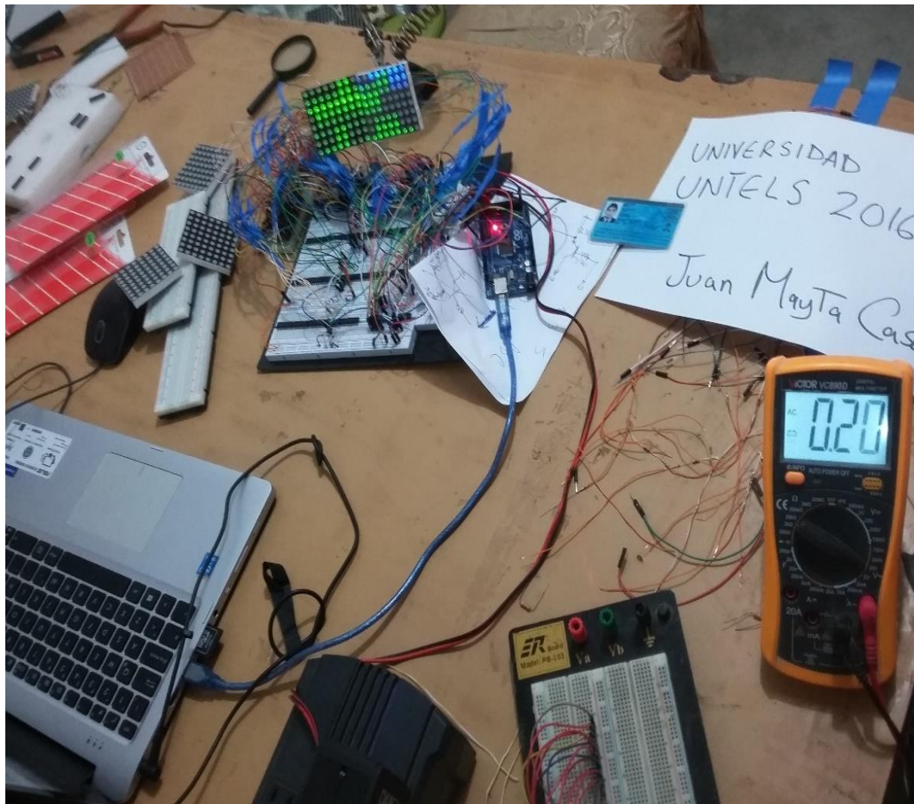
FIGURA 3.36: Fase inicial de la implementación del prototipo, conexionado y ensamblado de los módulos 8x8 de las matrices LED RGB
