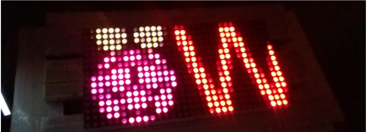
FIGURA 3.42: Logotipo de la placa Raspberry Pi mostrado en el prototipo de panel LED RGB 16x32.
