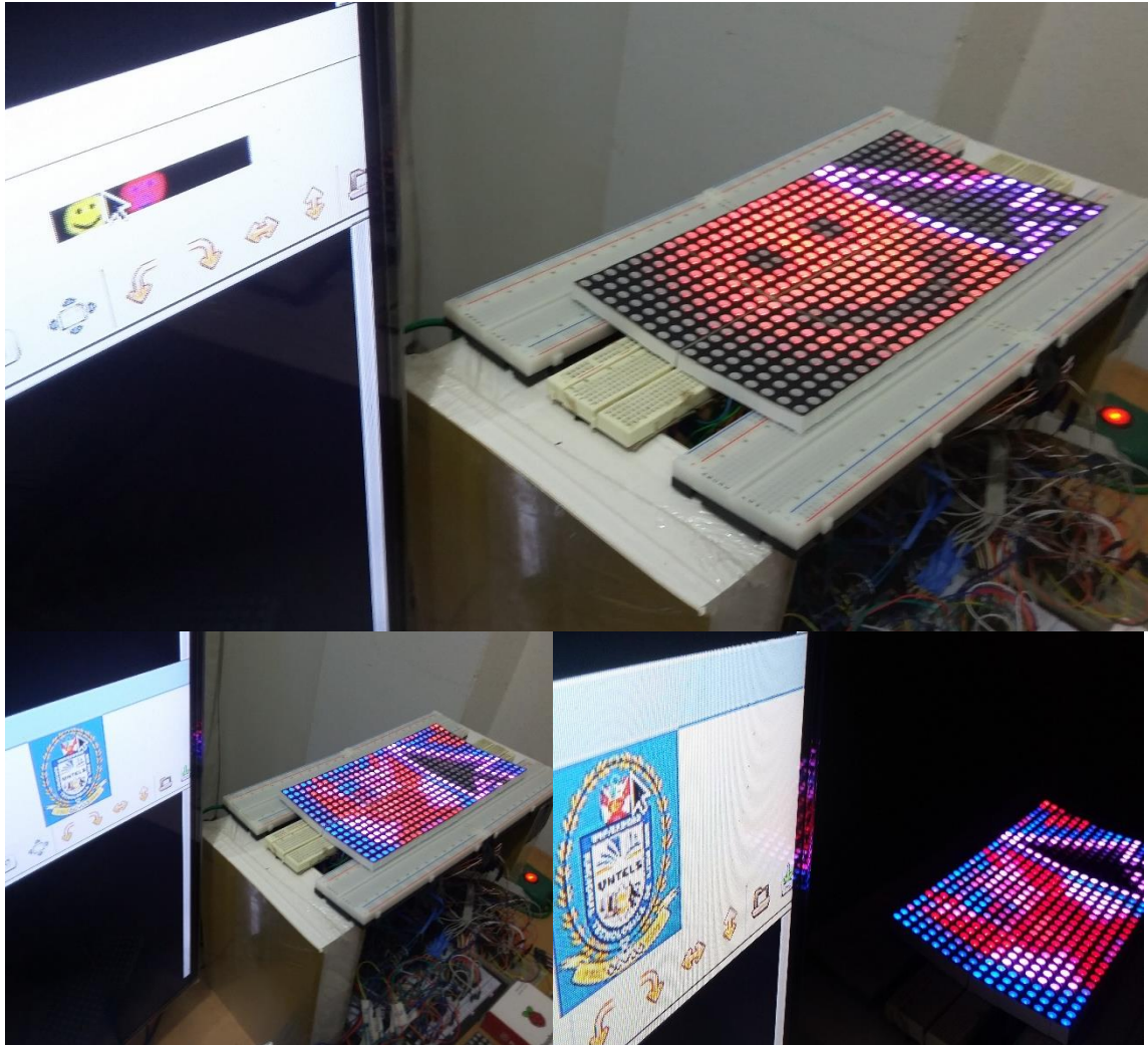
FIGURA 3.46: Visualización de parte de la pantalla del monitor de diferentes imágenes en el prototipo de panel LED RGB 16x32.
