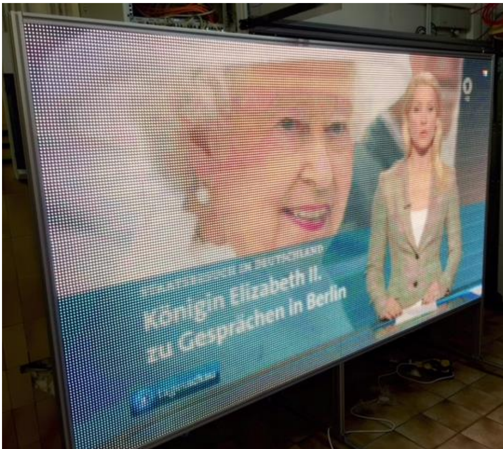
FIGURA 3.3: Display LED RGB formado por paneles LED RGB modulares
