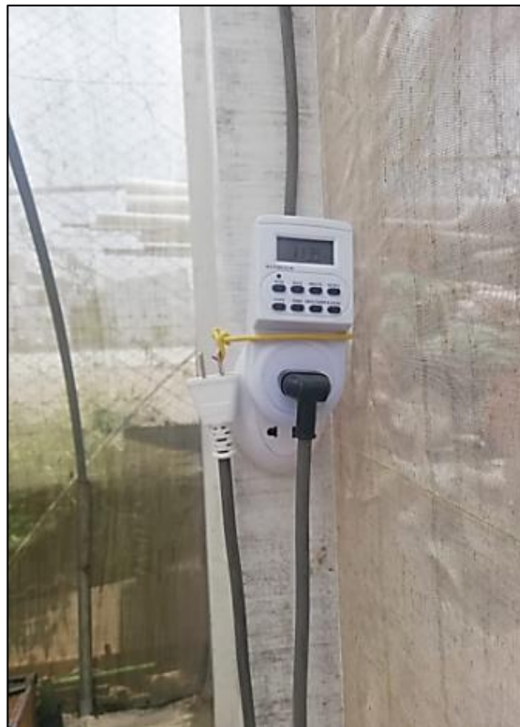
ANEXO 4: Temporizador que se usa en el invernadero multifuncional.
