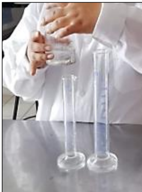
Figura 13: Estimación del volumen de la muestra de agua obtenida de un gotero
