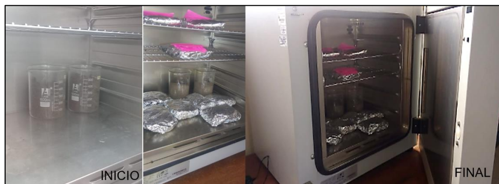
Figura 7: Muestra de suelo colocado a estufa por 24 horas a 105°C
