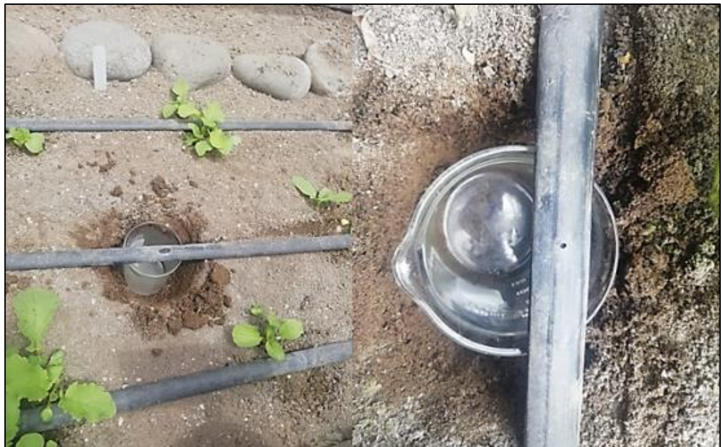
Figura 9: Colado del vaso beaker al ras del suelo
