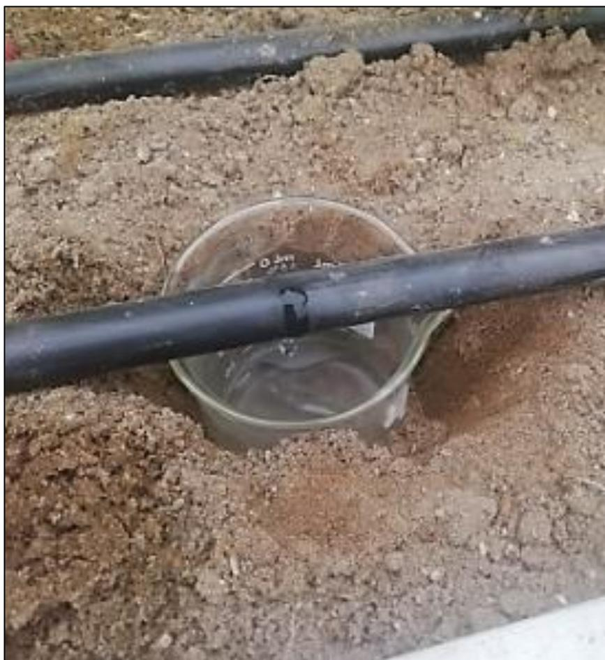
*Figura 10: Almacenando agua de un gotero*
