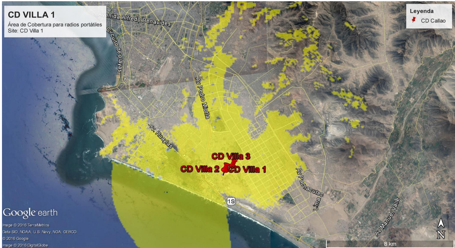
Figura 28: Área de cobertura de la CD Villa 1 para radio portátiles
