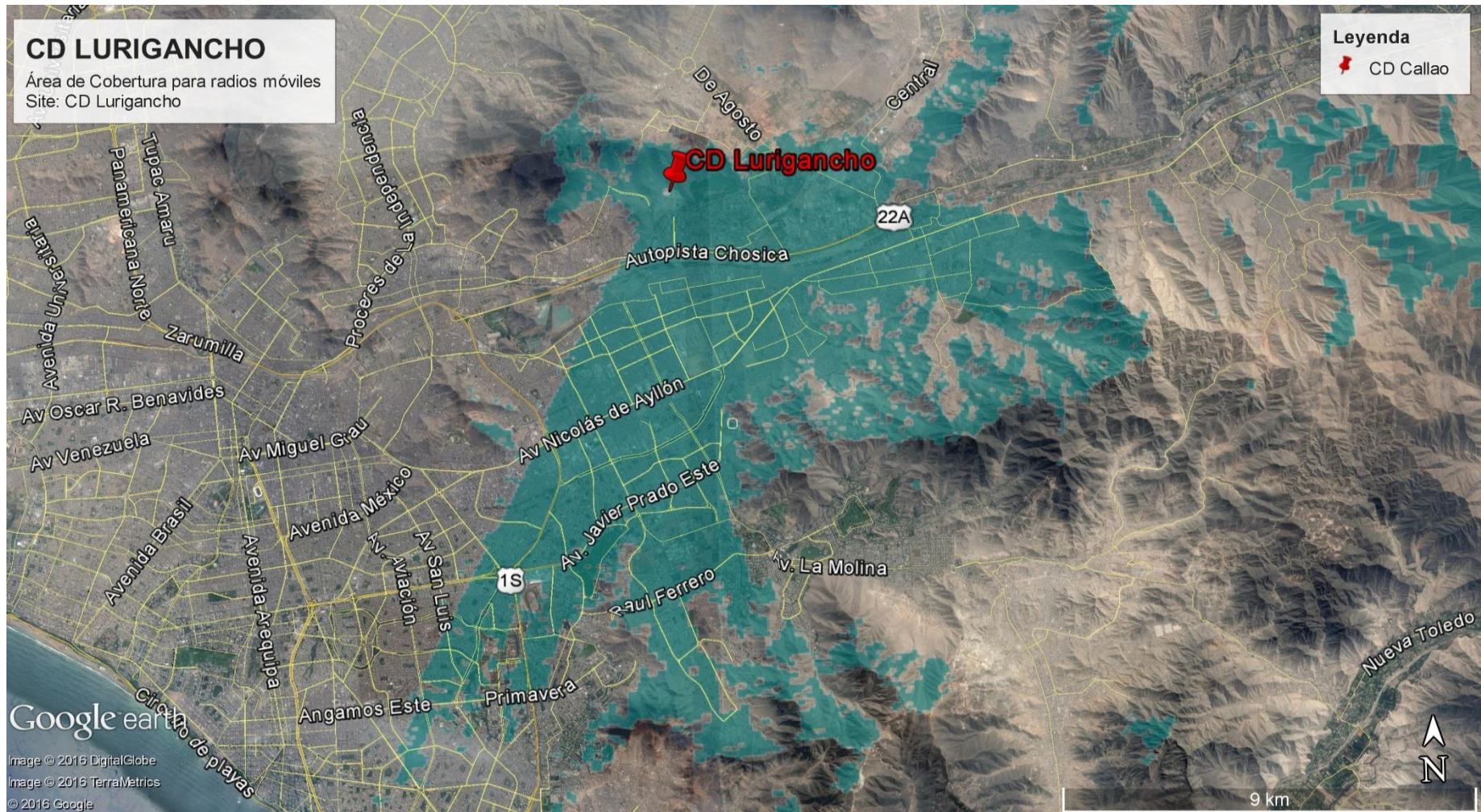
Figura 23: Área de cobertura de la CD Lurigancho para radio móviles
