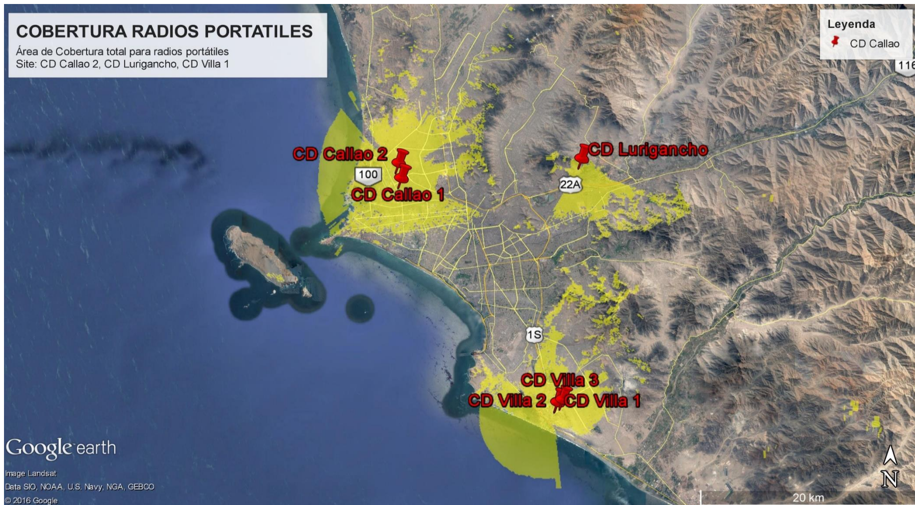
Figura 29: Área de cobertura Total para radios portátiles
