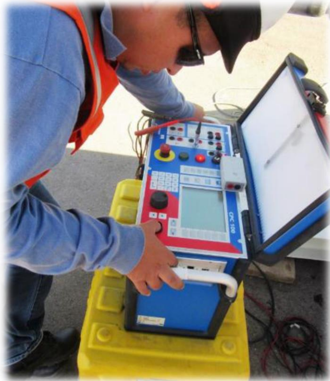
Foto 9. Pruebas Eléctricas al Reactor Nuevo de 30KVAr.
