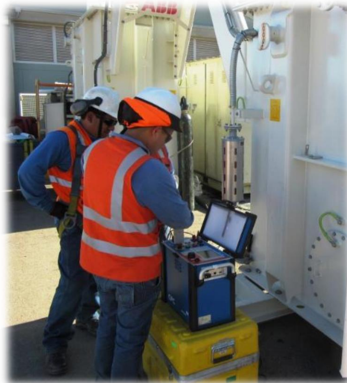
Foto 9. Pruebas Eléctricas al Reactor Nuevo de 30KVAr.
