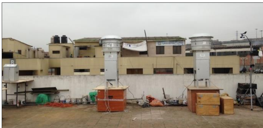
Figura 10: Fotografía de la instalación de los equipos de monitoreo
