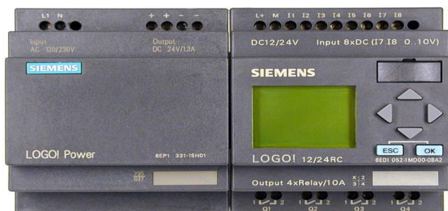
FIGURA 27. Equipo PLC siemens (circuito lógico programable).
