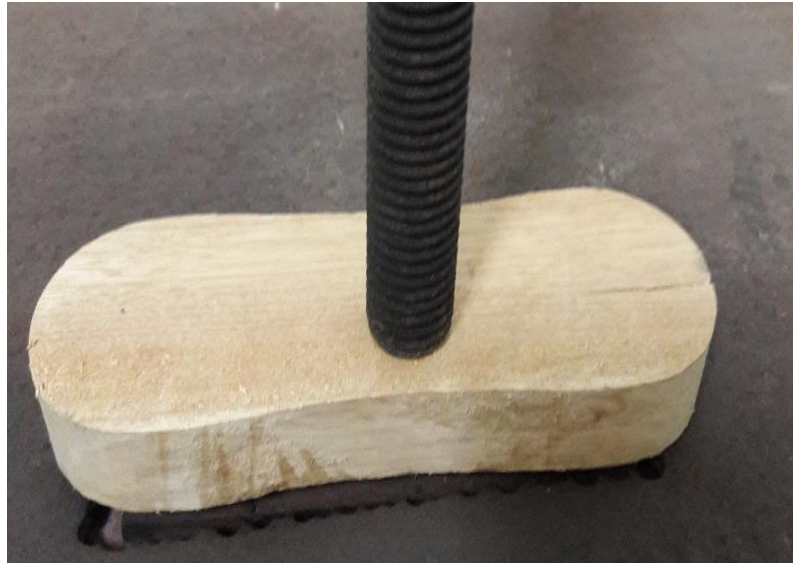
FIGURA 34. Proceso de sellado de escobillas para lavar ropa vástago realiza el presionado de la madera al sello.
