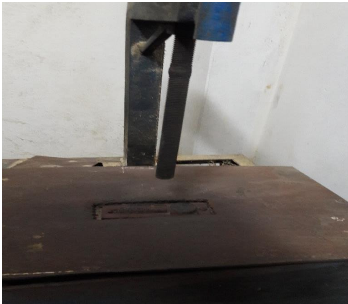
FIGURA 30. Máquina de sellado de escobillas para lavar ropa para molde de madera usada en la empresa REY LEÓN S.A.
