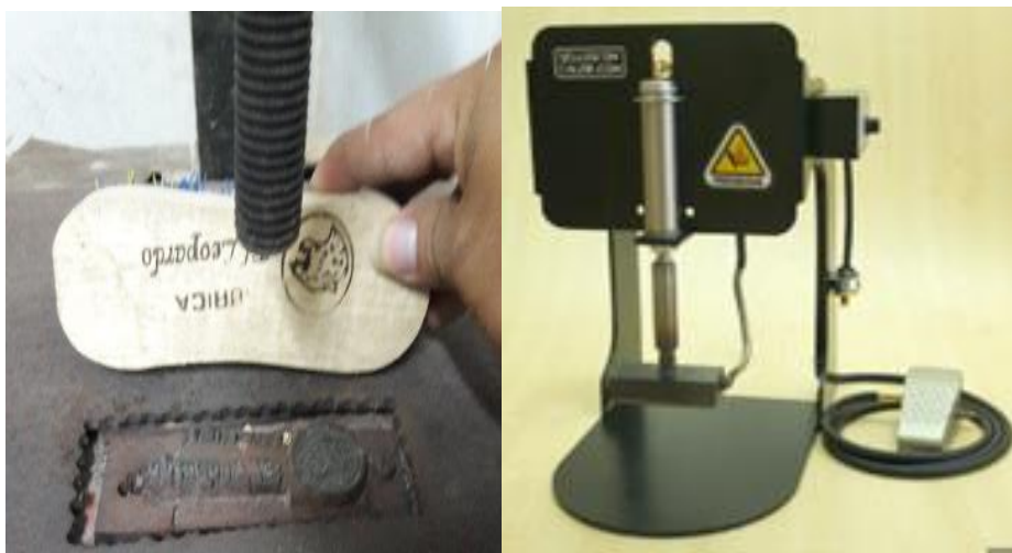
FIGURA 36: izquierda la maquina tiene el sellador en la parte inferior, mientras que a la derecha se observa que la maquina lleva el sellador en la parte superior.
