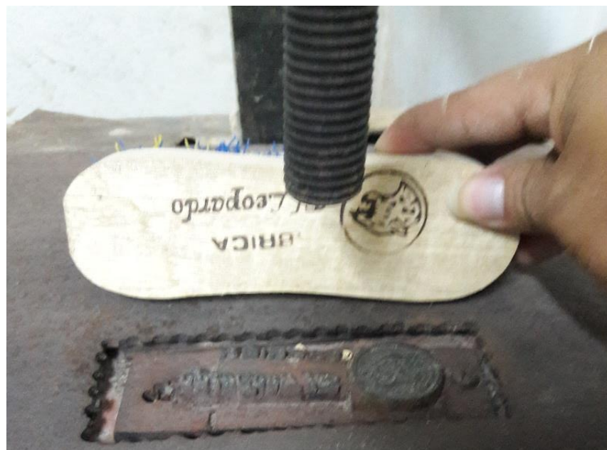
FIGURA 35. Resultado final del sellado de escobillas para lavar ropa la marca queda impregnada en la madera.
