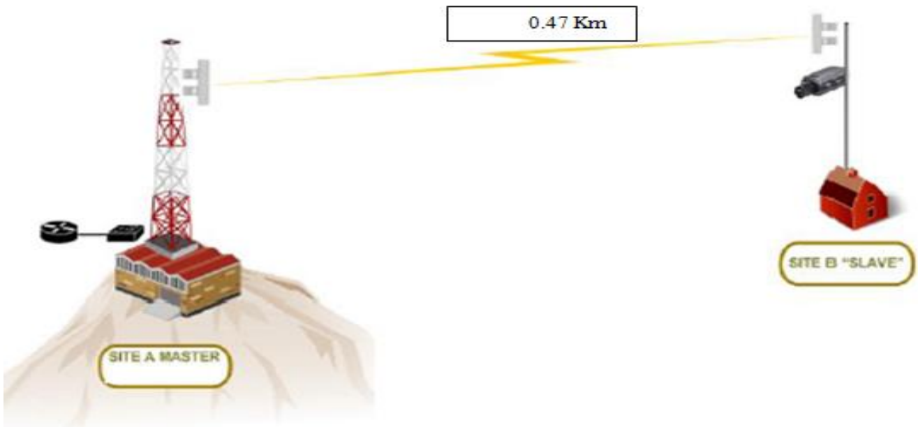
FIGURA 3.1 Topología del Radio Enlace
