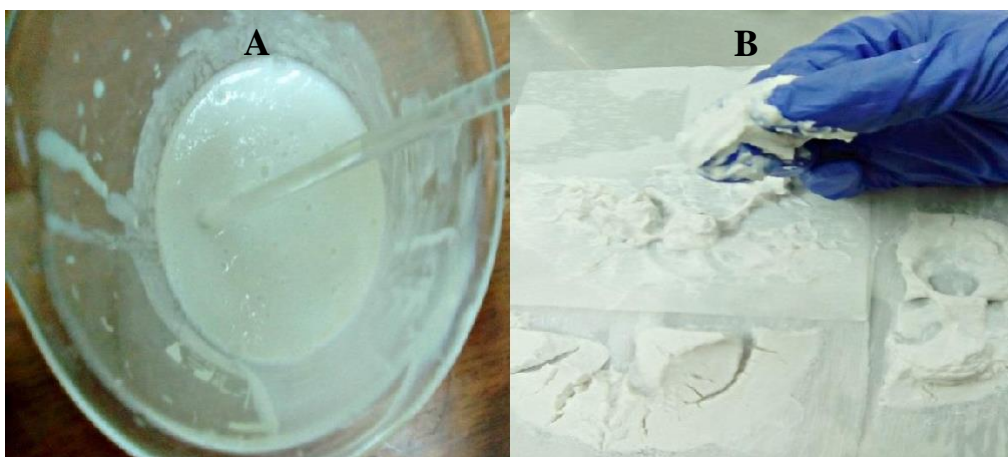
Imagen N°11: Lodo generado en el Tratamiento con HCl
