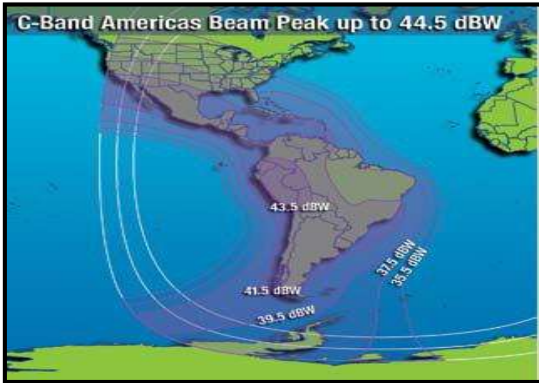
Figura 22: cobertura del satélite Intelsat 14 (45.0° oeste) en banda C.
