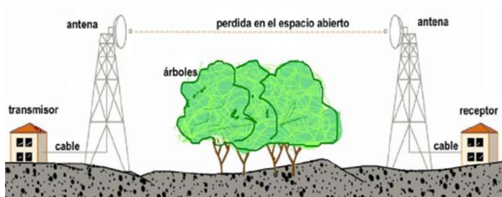
Figura 2.8: Trayectoria completa de transmisión entre el transmisor y el receptor.
