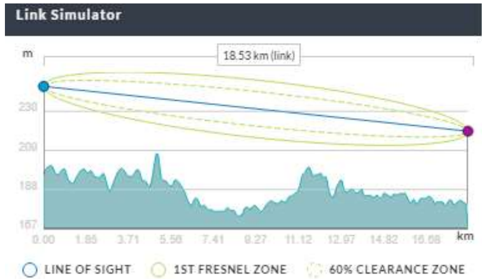
Figura 3.5: Línea de vista del enlace MW del Site Nueva Requena al Site Campo Verde.
