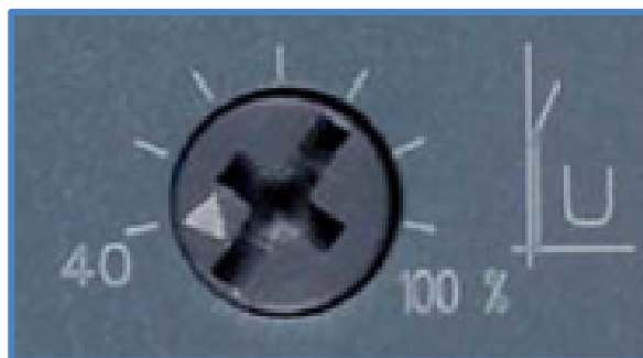
FIGURA N° 30: POTENCIOMETRO PARA EL AJUSTE DE LA TENSIÓN DE ARRANQUE
