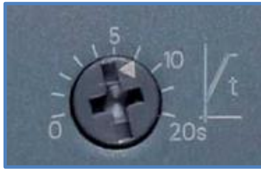
FIGURA N° 31: POTENCIÓMETRO PARA EL AJUSTE DEL TIEMPO DE RAMPA
