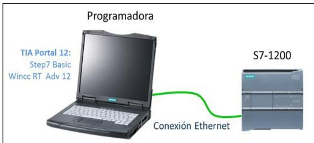
**Figura 27.** Comunicación de PLC y PC
