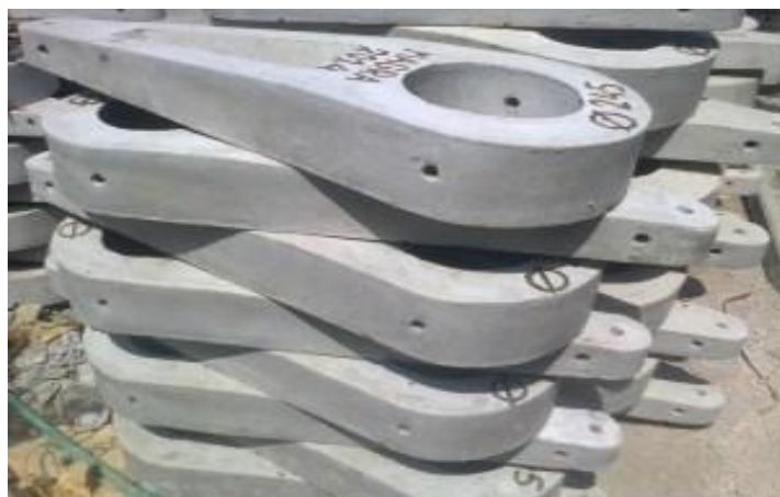
Figura 5. Ménsulas de concreto
