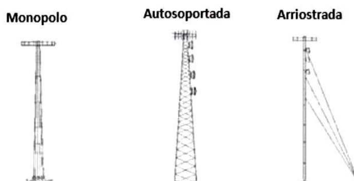
Figura 26: Tipos de torres de telecomunicaciones
