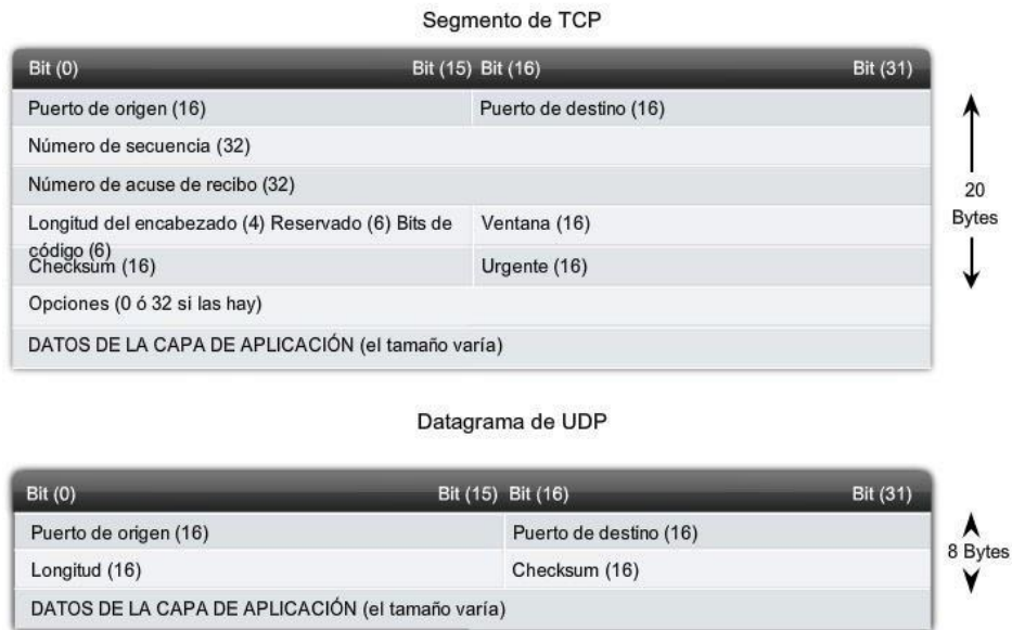
Figura 2.10: Encabezados de los protocolos de la capa de transporte. Fuente: Suarez, D. (2015).
