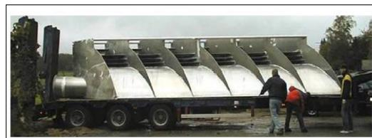
Figura 2.24.b Canales de recogida de las olas.<sup>(10)</sup>
