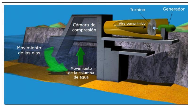
Figura 2.18. Instalaciones de columna oscilante de agua (OWC) <sup>(10)</sup>
