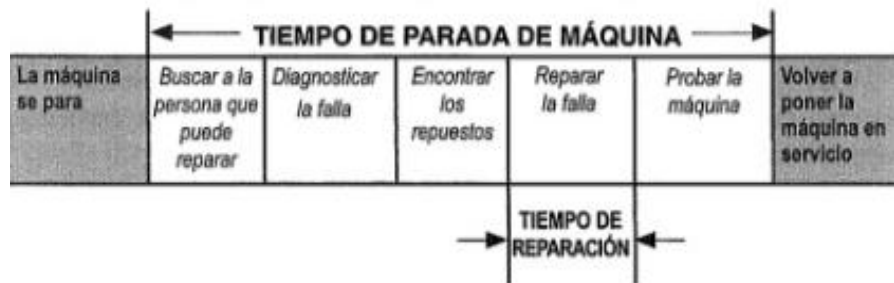
Figura 10. Tiempo de parada de máquina vs tiempo de reparación. Fuente: Moubray, J. (2008). Mantenimiento Centrado en la Confiabilidad.
