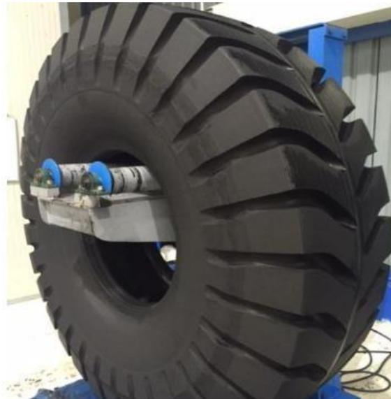
**Figura 3.7** Neumático OTR reencauchado.
