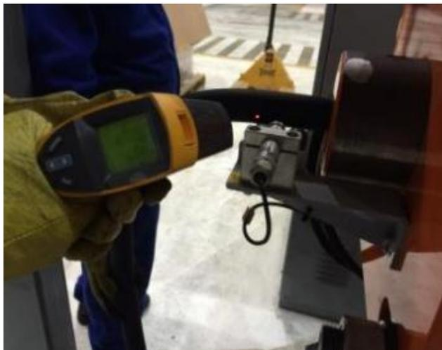
**Figura 3.5** Control de temperatura en extrusado.
