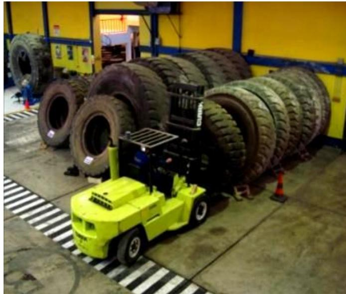
**Figura 3.2** Traslado de neumáticos con montacargas.
