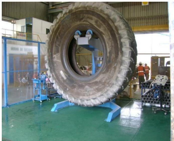
**Figura 3.3** Neumático en soporte OTR.
