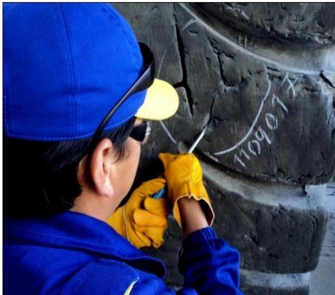
**Figura 3.8** Evaluación e inspección inicial en el raspado.
