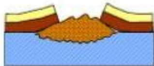
Área con daño y/o Oxido
