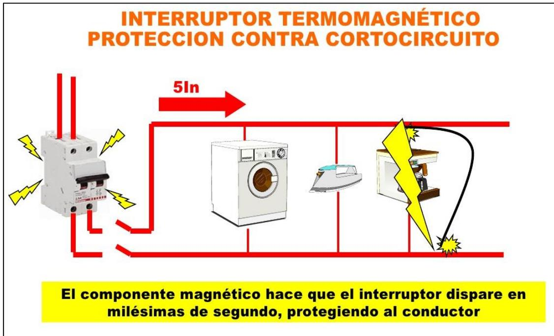
**Figura 18.** Quispe, J. (2011). Representación de cortocircuito en un circuito eléctrico. [Figura]. Recuperado de <https://es.slideshare.net/juanquispe/tema-3-partes-de-una-instalacion-electrica>
