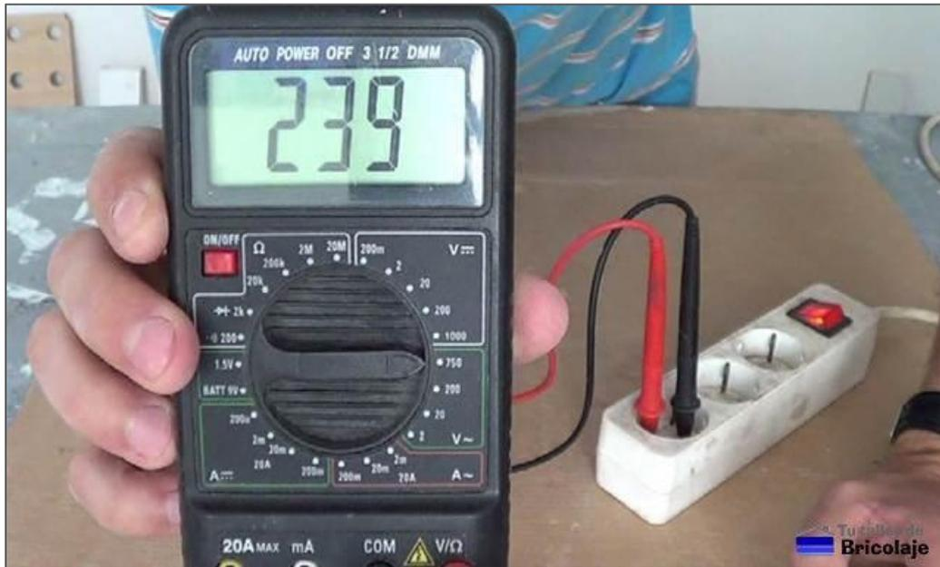
**Figura 15.** Bricolaje. (2013). Medición de voltaje de valor inadecuado según CNE. [Figura]. Recuperado de <https://tutallerdebricolaje.com/tutorial-basico-de-como-usar-un-multimetro-o-tester-digital/>
