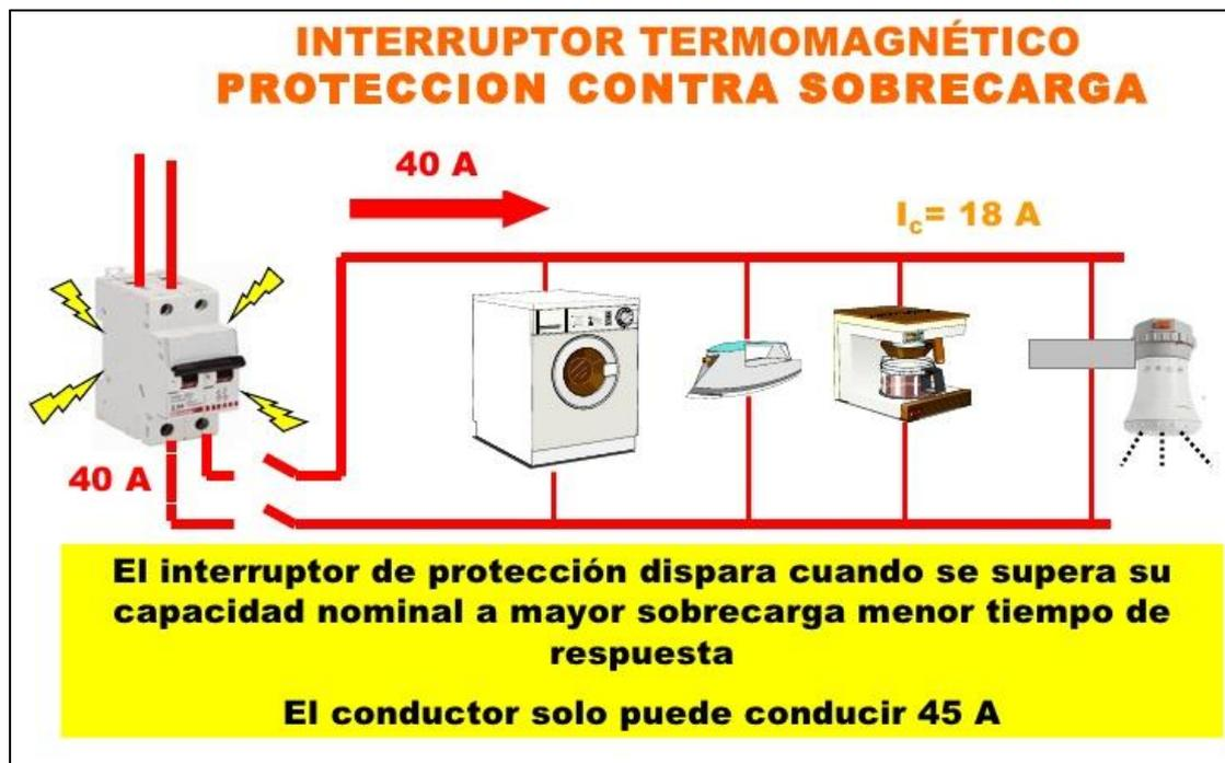
**Figura 17.** Quispe, J. (2011). Representación de sobrecarga en un circuito eléctrico. [Figura]. Recuperado de <https://es.slideshare.net/juanquispe/tema-3-partes-de-una-instalacion-electrica>
