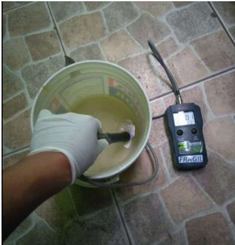
Imagen 3.2. Análisis de la Conductividad Eléctrica de las aguas residuales
