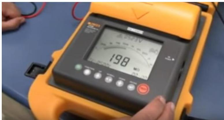
*Figura 29: Medición con Megóhmetro*
