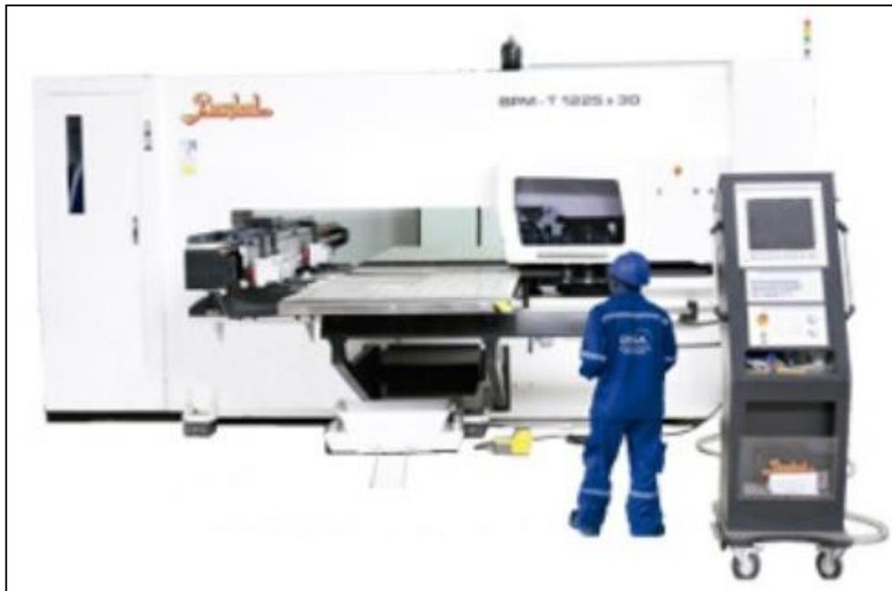
*Figura 22: Proceso de punzonado de las planchas metálicas cortadas.*
