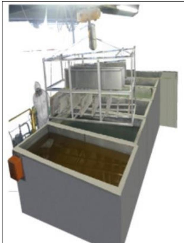
*Figura 25: Proceso de Fosfatizado*
