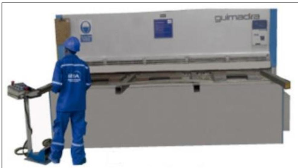
*Figura 21: Proceso de corte de la Plancha Metálica.*
