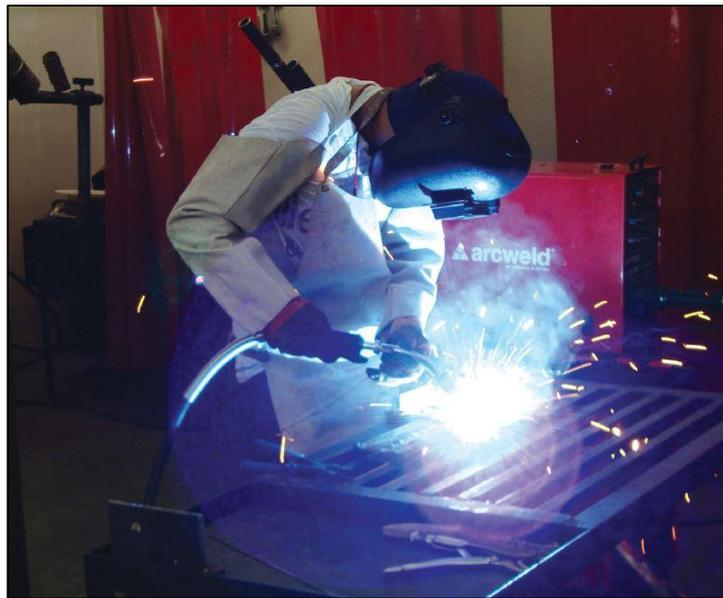
*Figura 24: Proceso de Soldadura para el armado de los Gabinetes del Tablero Eléctrico.*
