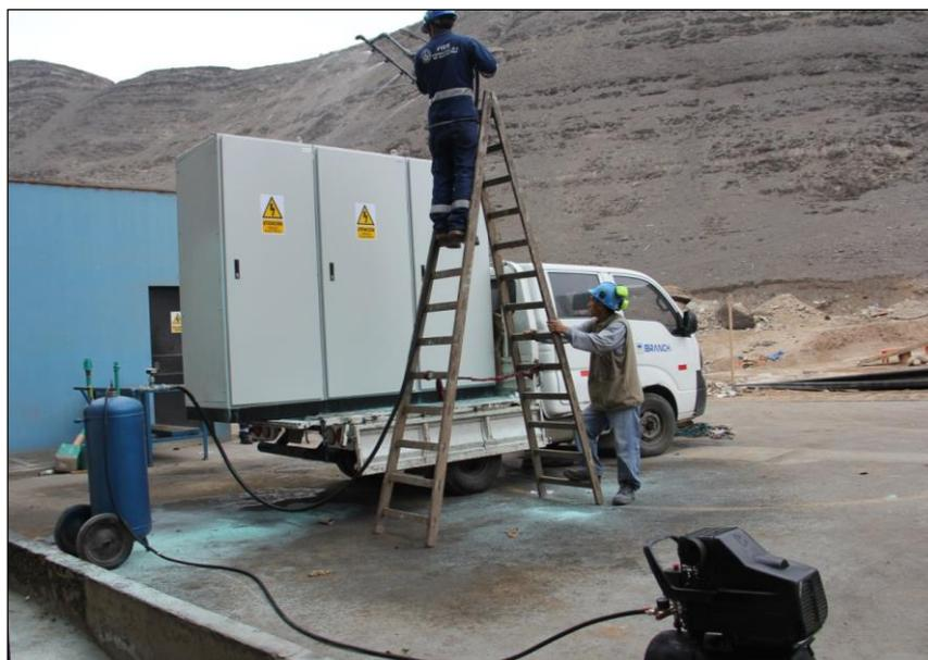
*Figura 3: Prueba de la protección IP. Fuente: LAB. N° 6 FIEE – UNI.*
