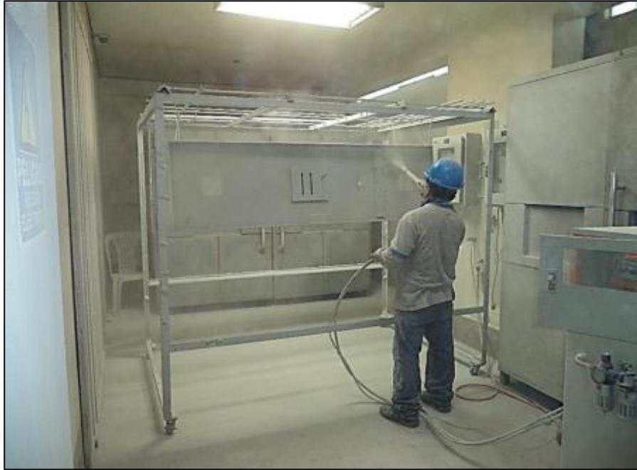
*Figura 26: Proceso de pintado electrostáticamente.*
