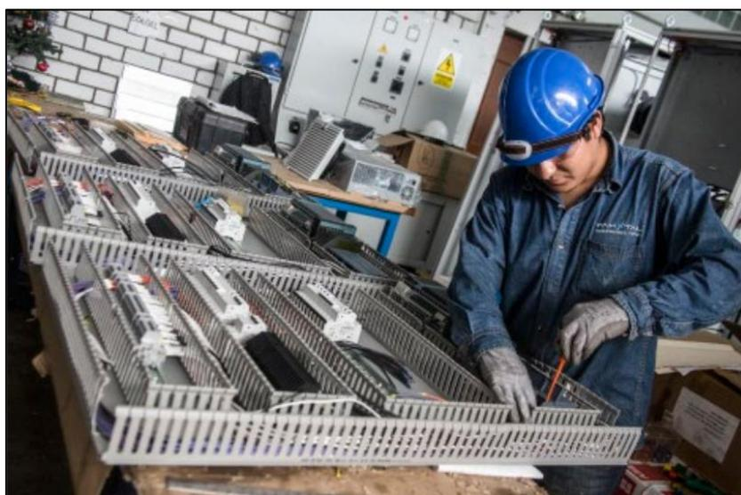
*Figura 28: Proceso de Cableado de los equipos eléctricos.*
