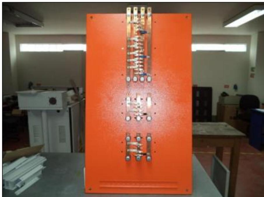
*Figura 27: Panel de Barras y conectores de cobre*
