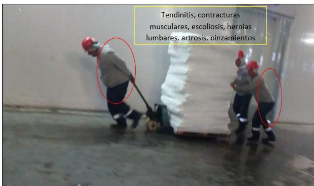
**Figura 3.** Peligro de tipo ergonómico por sobreesfuerzo, realizado por los estibadores de la empresa Inv.Kallpa Sur Sac
