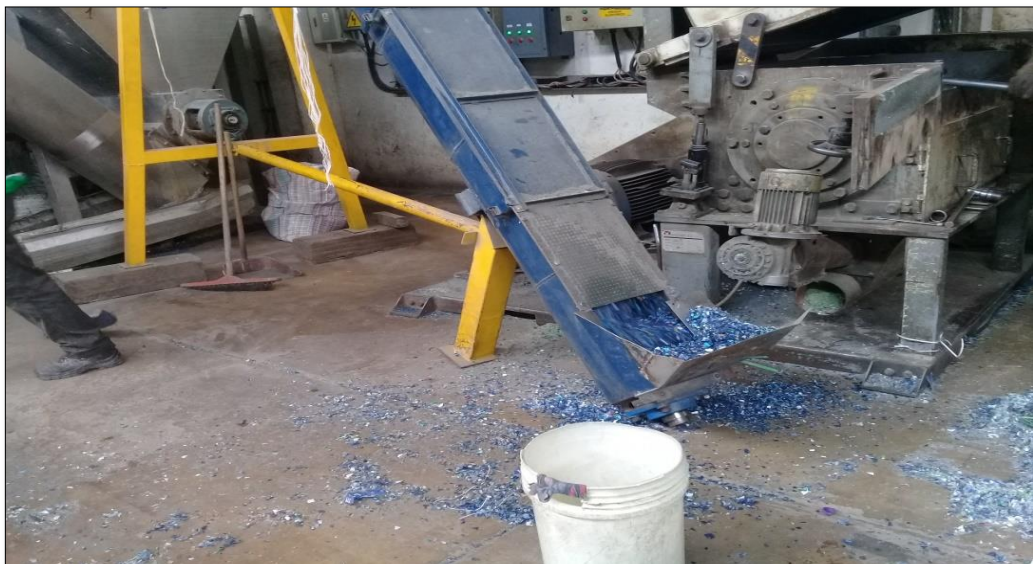
Figura 12. Cortado de las botellas de PET en escamas de PET
