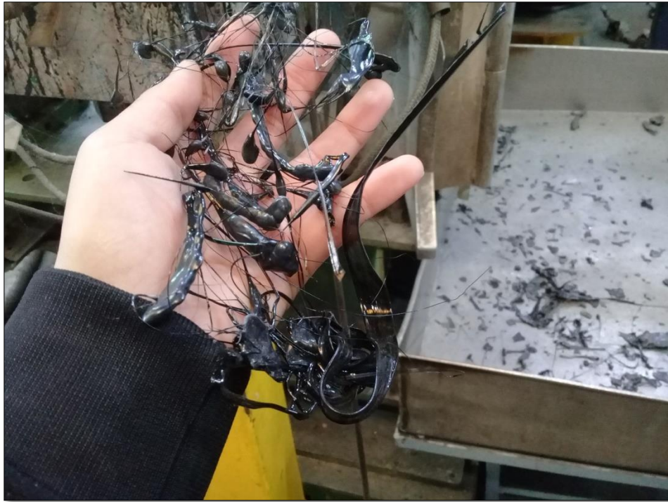
Anexo 8: Nastro generado por el Mezclador y cristalizador de escamas de PET
