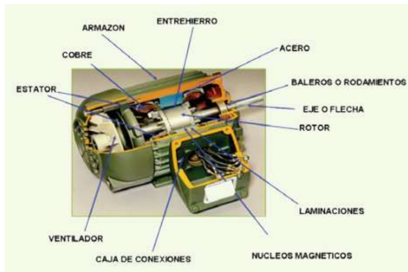
Figura 9: Componentes de un motor eléctrico
