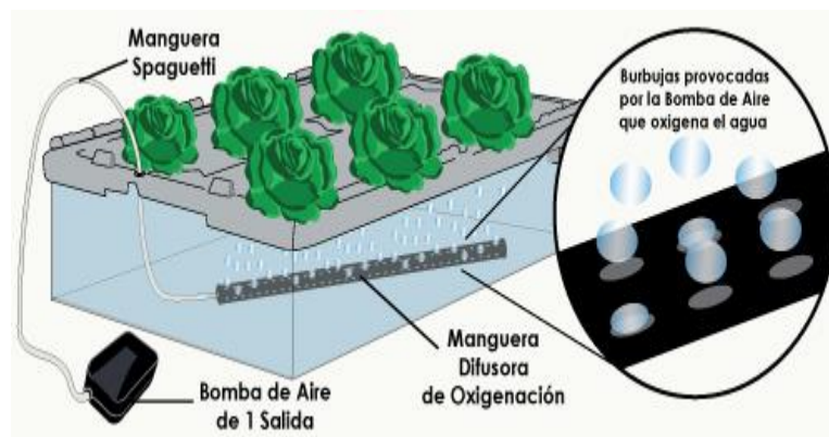
Figura 4. Esquema hidropónico de Raíz Flotante.
