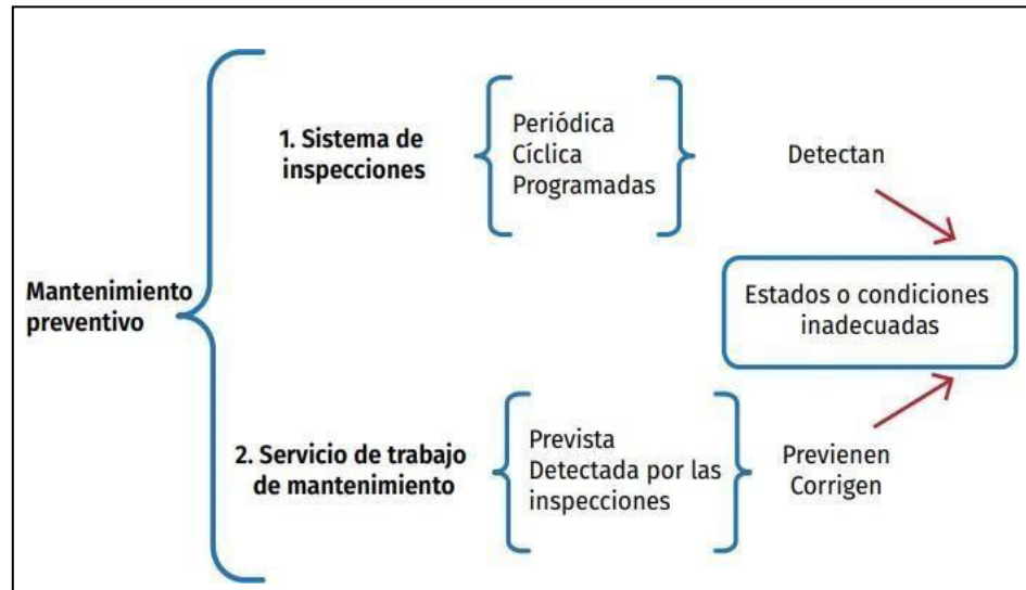
Figura 5. Implementación del mantenimiento preventivo. Fuente: (Pérez, 2021)
