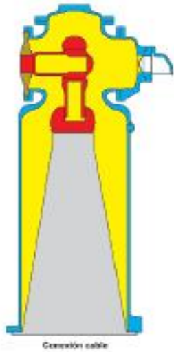
Figura 19 Compartimentos de paso a líneas aéreas
