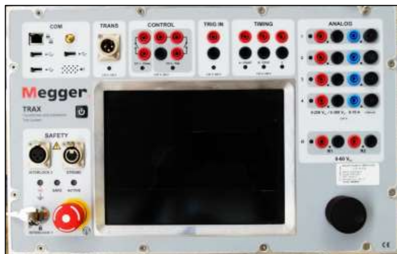
Figura 17: Panel frontal del equipo Trax Megger utilizado en las mediciones.
