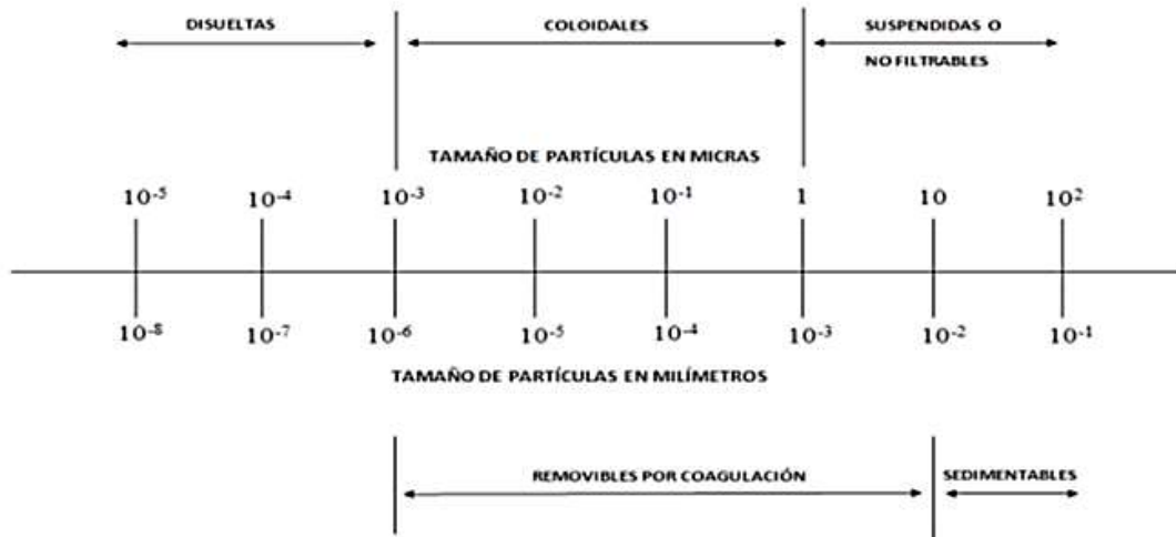
FIGURA 2. Clasificación de los Sólidos de acuerdo con el tamaño de partícula. Fuente: Validación de los métodos de ensayo para Fenoles, Tensoactivos, Sólidos Suspendidos y Total de Sólidos Disueltos (TDS). 2012.
