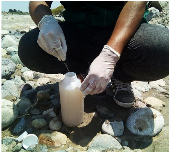
Figura 31. Preservación de la muestra con ácido nítrico
