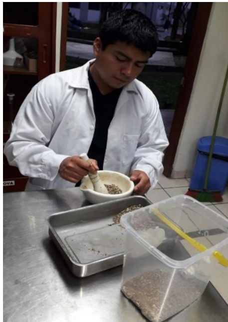
Descripción: secado a estufa y molido de opuntia ficus indica para su posterior tamizado
