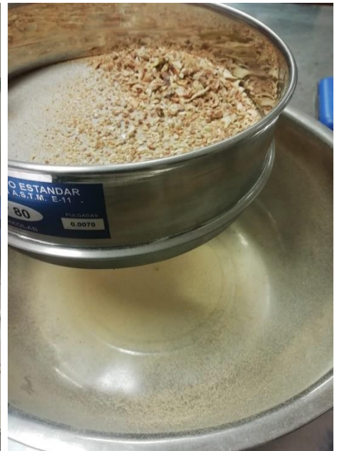
Descripción: secado a estufa y molido de opuntia ficus indica para su posterior tamizado
