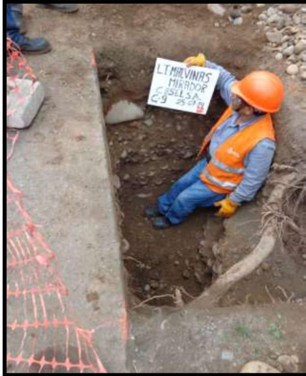
FIGURA. N° 18: VISTA DE PERFIL MOSTRANDO LA CALICATA C-9.
