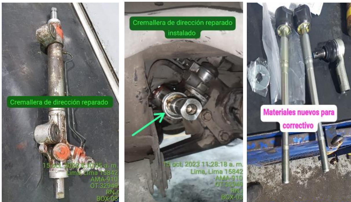
Figura 13: Cremallera de Dirección-Terminales
