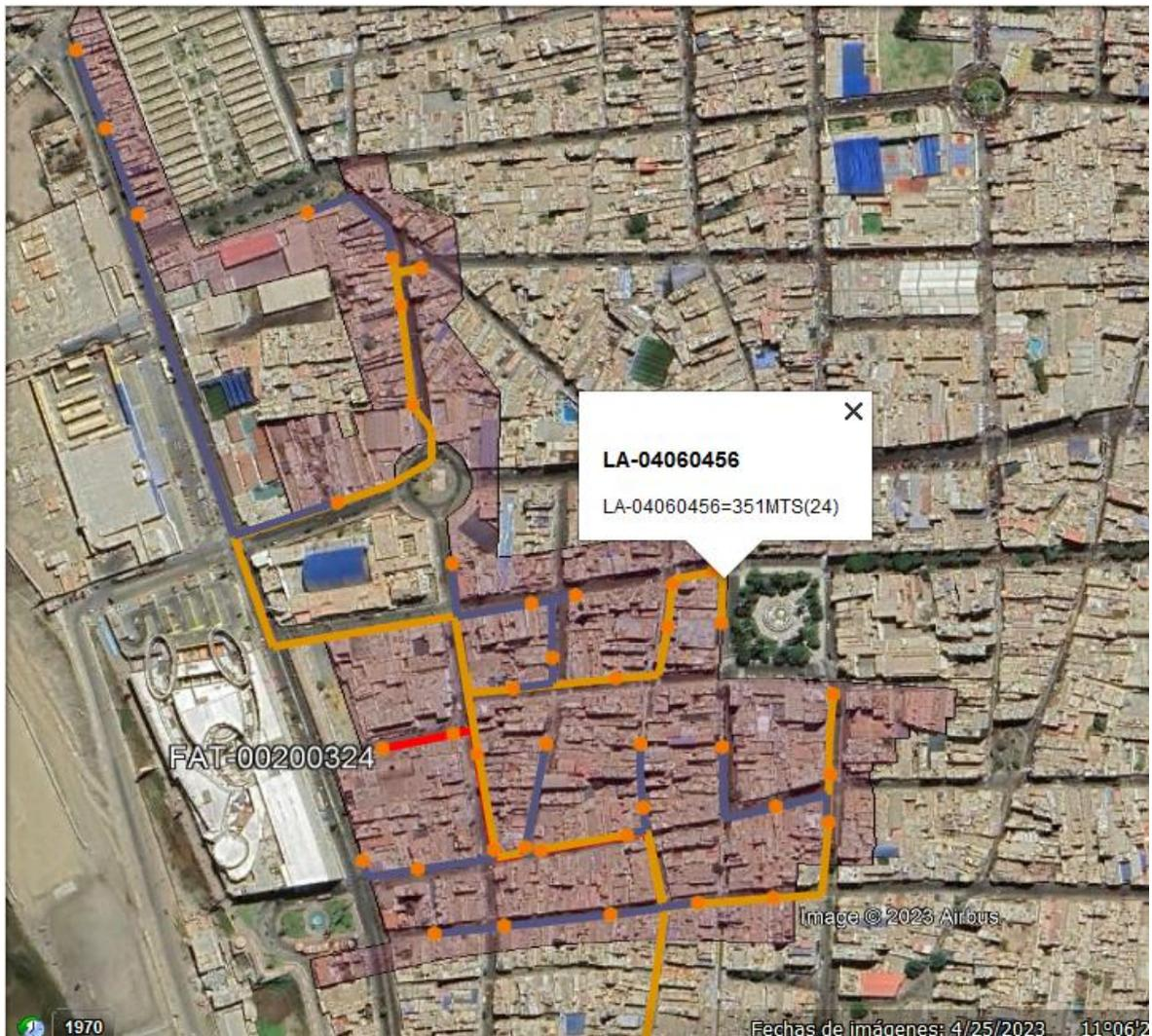
Figura 25. Recorrido de laterales de fibra óptica y cajas FAT.
