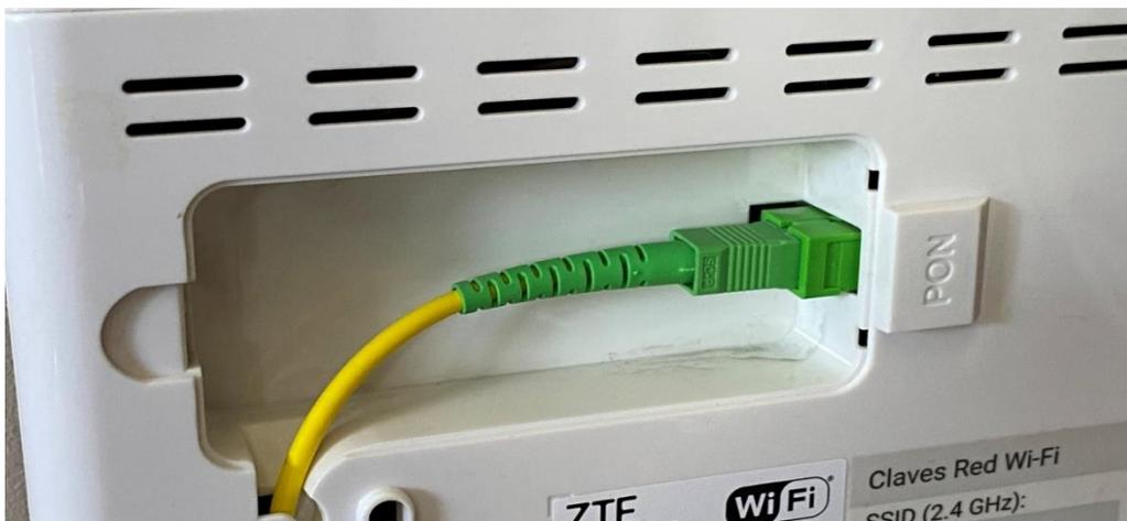
Figura 9. Terminal de nodo óptico
