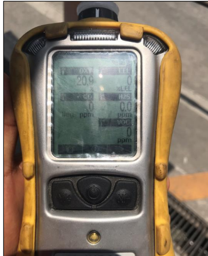
Figura 04. Equipo de medición Multi – Gas de marca RAE Systems INC. Equipo utilizado para la medición de la zona de trabajos
