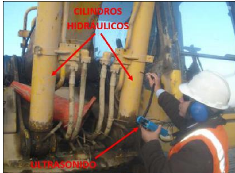
Figura 52. Prueba de cilindros hidráulicos por ultrasonido
