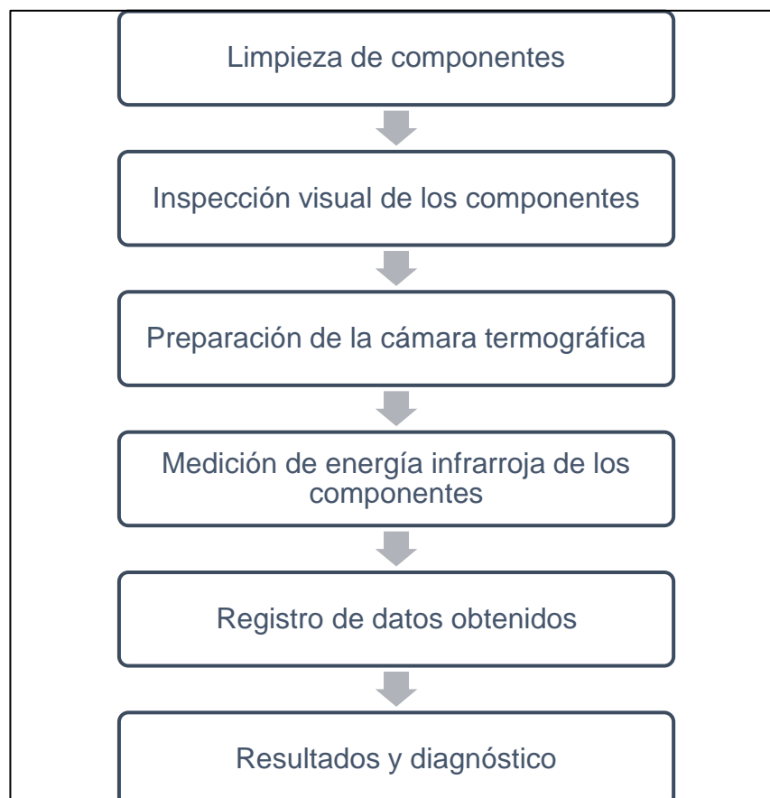
Figura 64. Procedimiento para ejecución de mantenimiento predictivo por termografía
