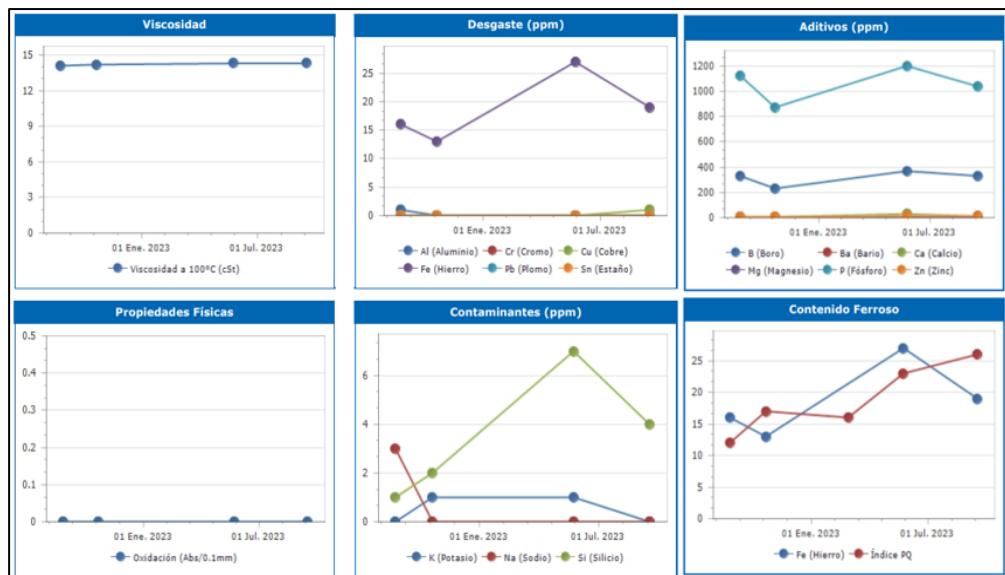
Figura 34. Resultados análisis de aceite del motor de giro LH del equipo M161857
