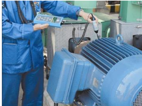
Figura 12. Aplicación del ultrasonido en un equipo rotativo
