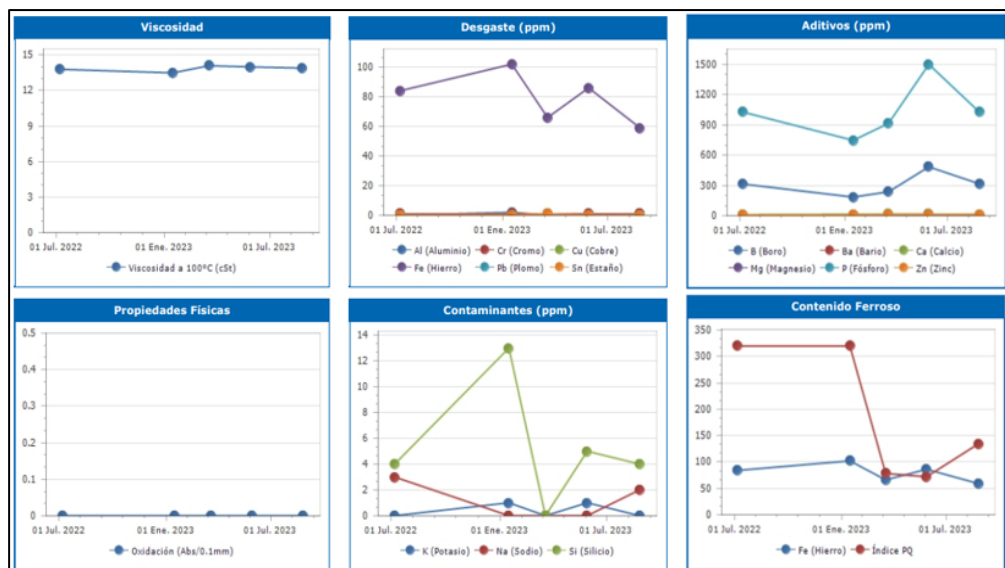
Figura 40. Resultados de análisis de aceite del mando final LH del equipo M161859
