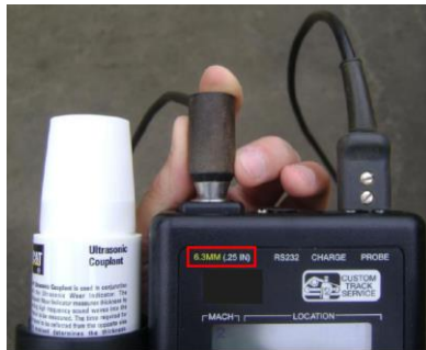
Figura 54. Herramienta ultrasonido para medición de tren de rodamiento
