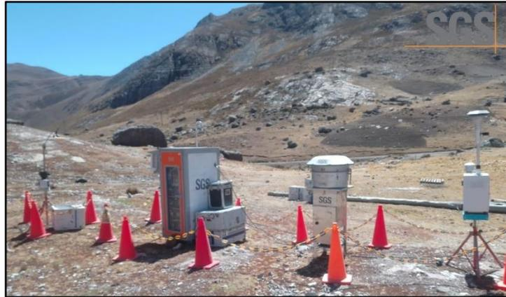
d) Una vez terminado el tiempo de monitoreo, se recuperan los filtros muestreados a la par que se descargan los datos de los equipos de medición en tiempo real.
