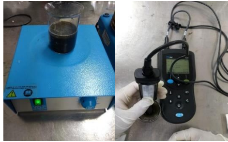
Figura N° 15: Agitación y lectura de pH
