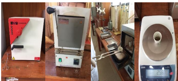
Figura N° 19: Secado, calcinación y pesado final
