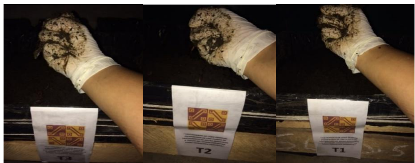
Figura N° 17: Control de humedad
