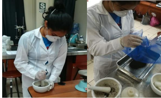
Figura N° 13: Molienda y tamizado de muestras
