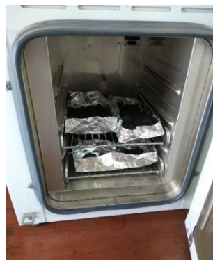
Figura N° 12: Secado de muestras
