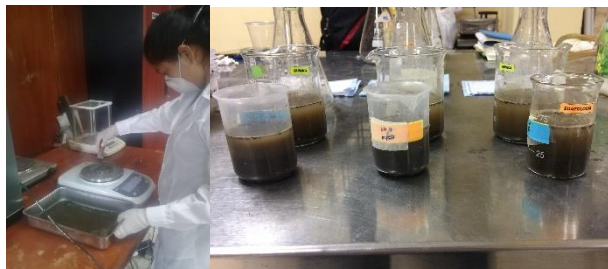
Figura N° 14: Pesado y dilución de las muestras
