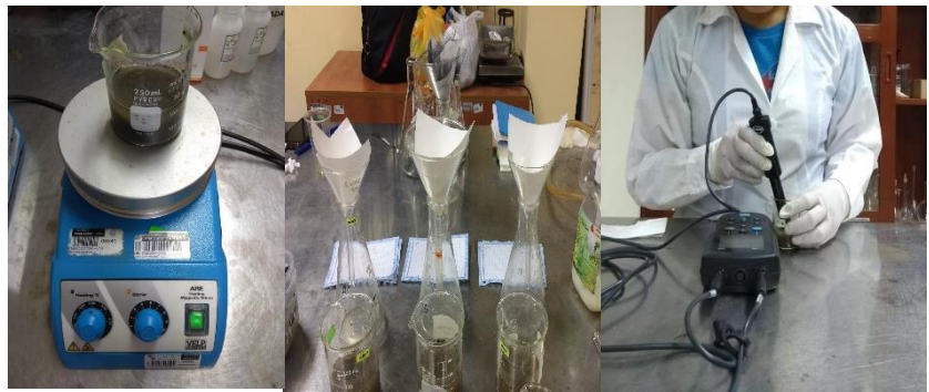
Figura N° 16: Agitación, filtración y lectura de C.E
