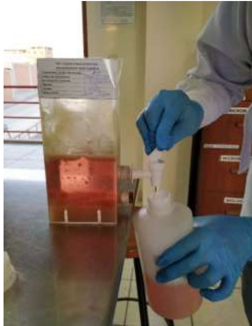
Figura 38. Llenado de las botellas utilizando el caño del reactor
