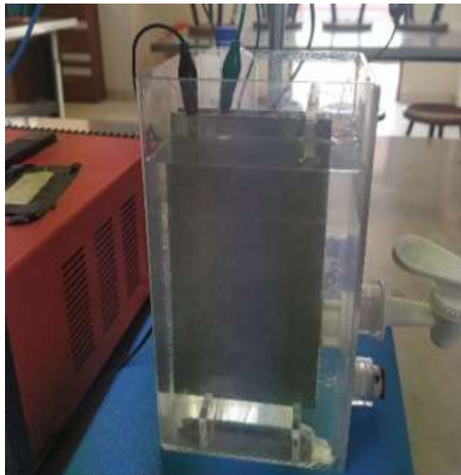
Figura 26. Electrodo de aluminio usados como cátodos y ánodos
