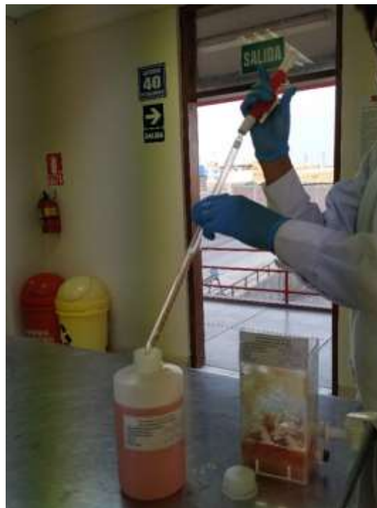
Figura 39. Llenado de las botellas utilizando una pipeta
