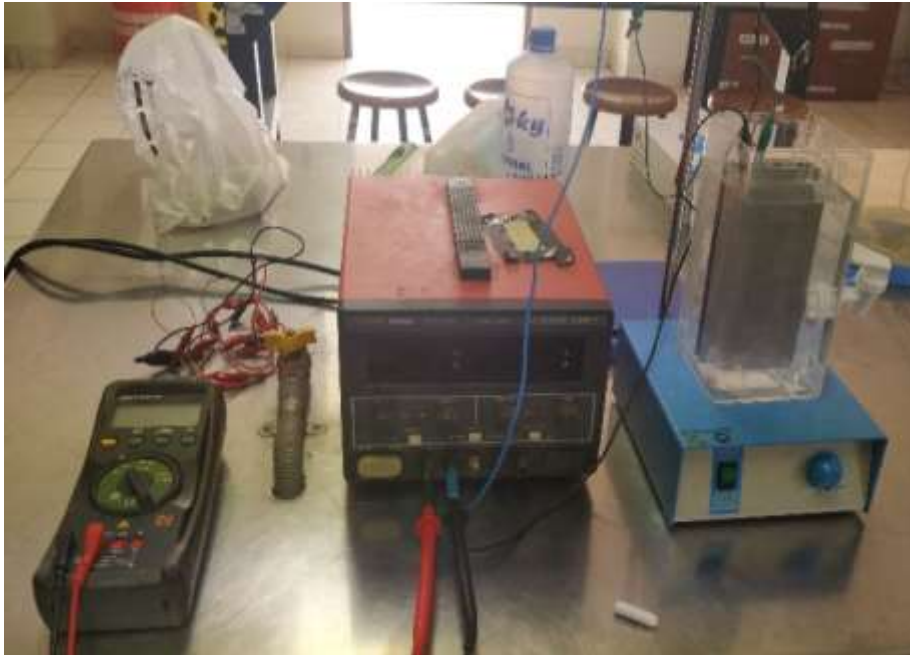
Figura 25. Sistema de electrocoagulación
