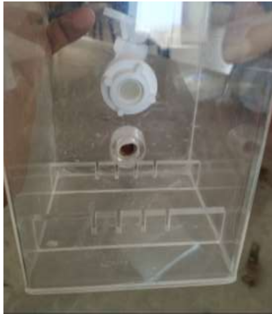
Figura 12. Reactor Tipo Batch, separación entre placas de 10mm
