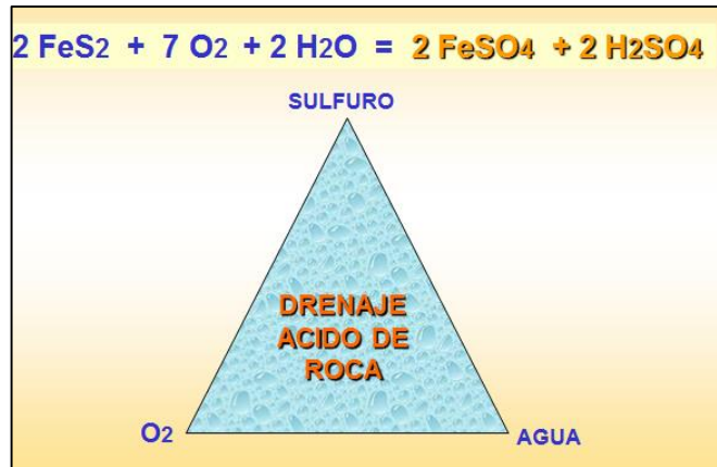
Figura 4: Principio de la generación del drenaje ácido.
