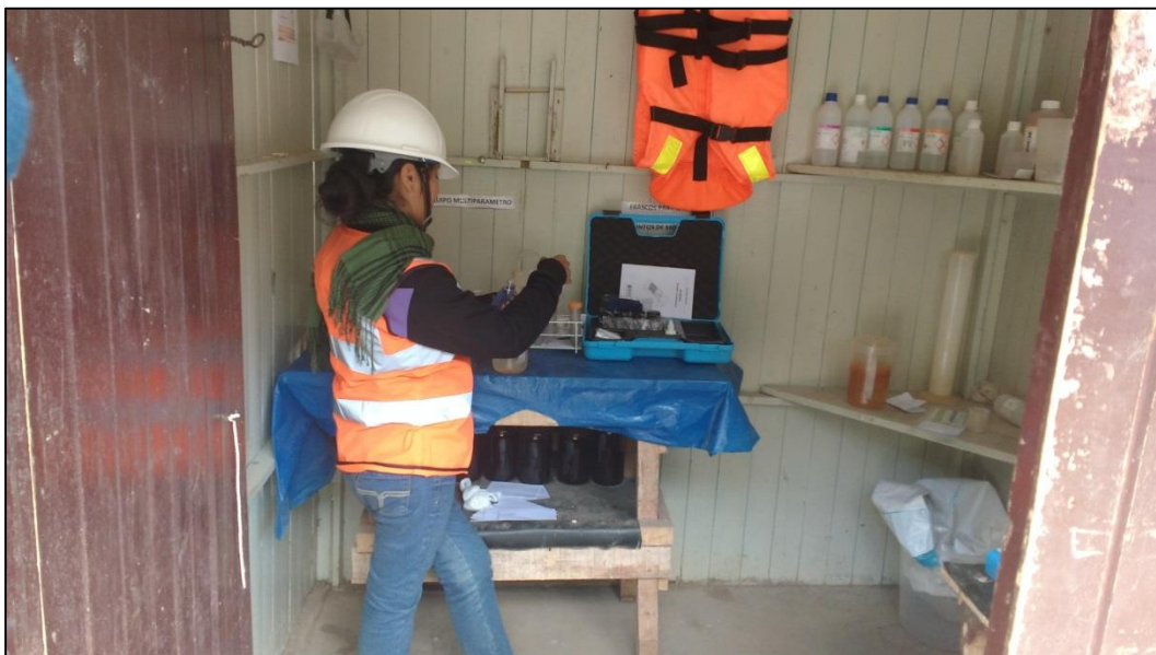
Foto N°4: Medición de parámetros de campo con equipos Multi-parámetro HANNA.
