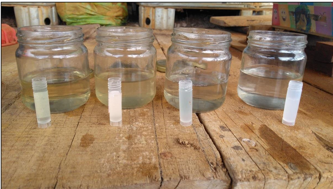
Foto N°11: Incorporación de solución de hidróxido de calcio.
