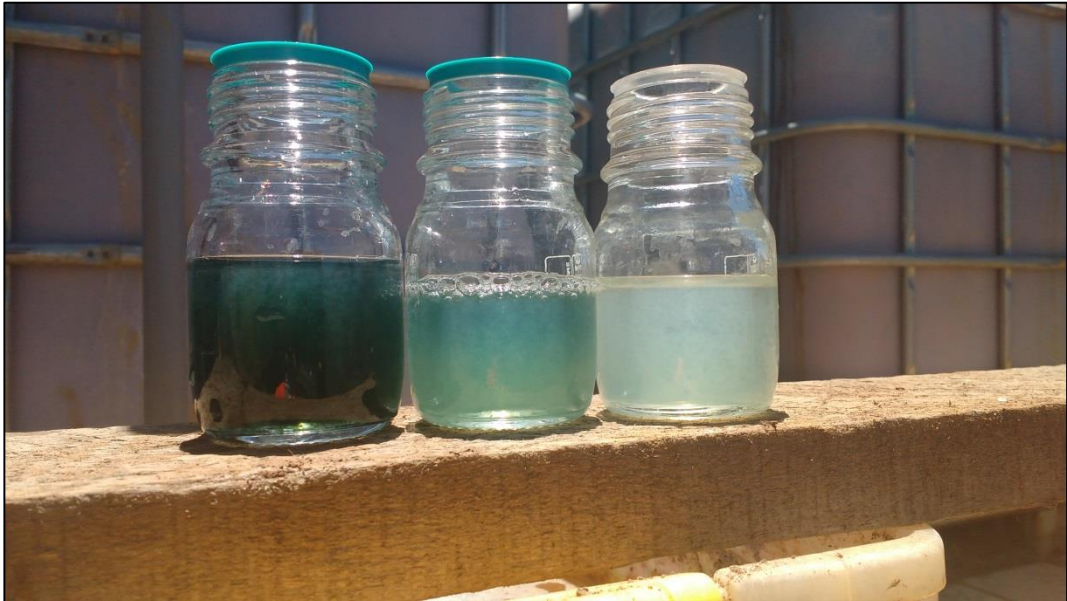
Foto N°12: Muestras después de la incorporación de solución de hidróxido de calcio en el sistema B.
