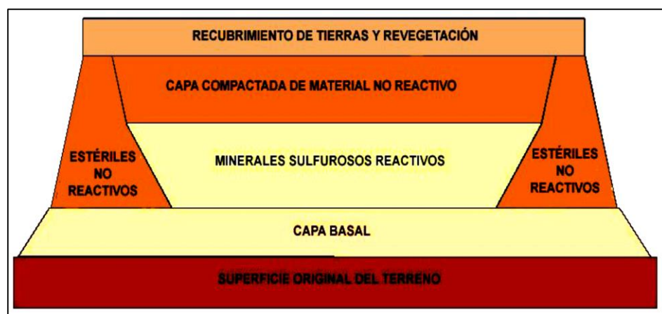
Figura 11: Colocación selectiva de materiales contaminantes por encapsulamiento.
