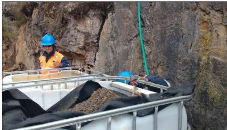
Figura 39: Incorporación de guano de alpaca al tanque A, guano de vaca al tanque B.
