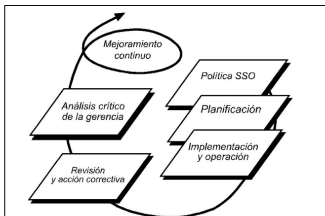
Figura 2: Modelo del Sistema de Gestión de Seguridad y Salud en el Trabajo. Por OHSAS 18001 (2007)
