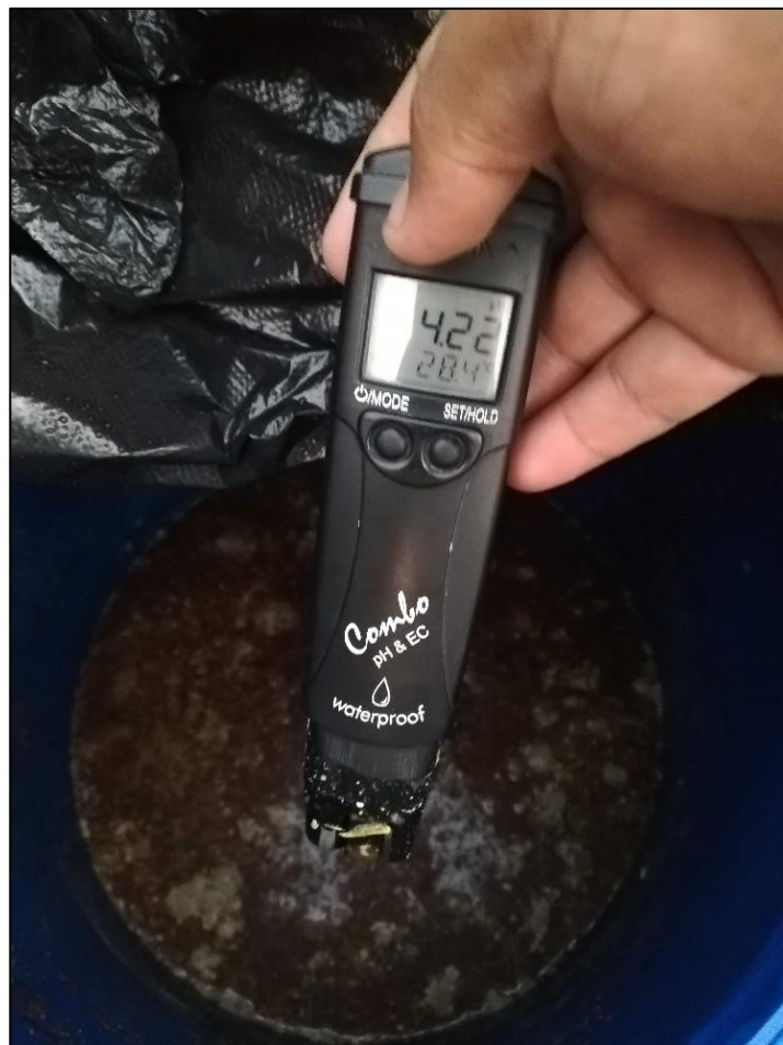
Figura 37. Medición directa de pH en reactor
