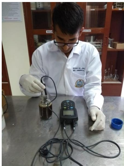
Figura 38. Medición de conductividad eléctrica y pH del compost. Fuente: Elaboración propia
