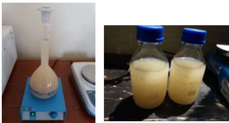
Figura 11. a. Preparación del coagulante natural al 0.5% de concentración llevado a agitación. b. Solución del coagulante natural homogéneo.
