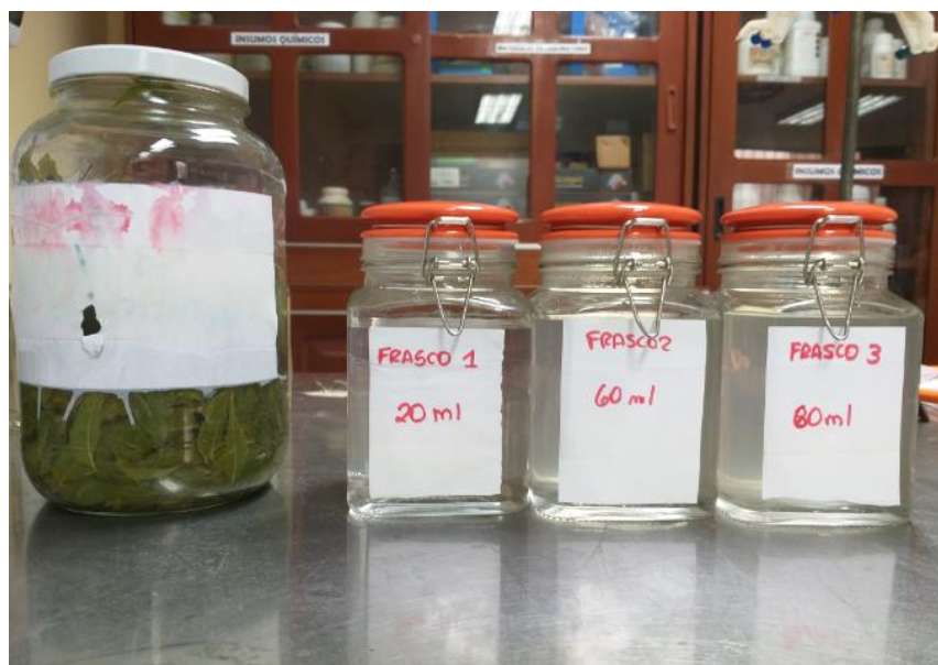
Figura 20: Envases con biopesticida por fermentación a diferentes concentraciones
