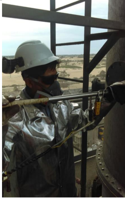
FOTO 07. ANALISTA DE CAMPO REALIZANDO LA MEDICIÓN ISOCINETICA EN EL PUERTO DE MUESTREO DE LA CHIMENEA DE FUNDICIÓN
