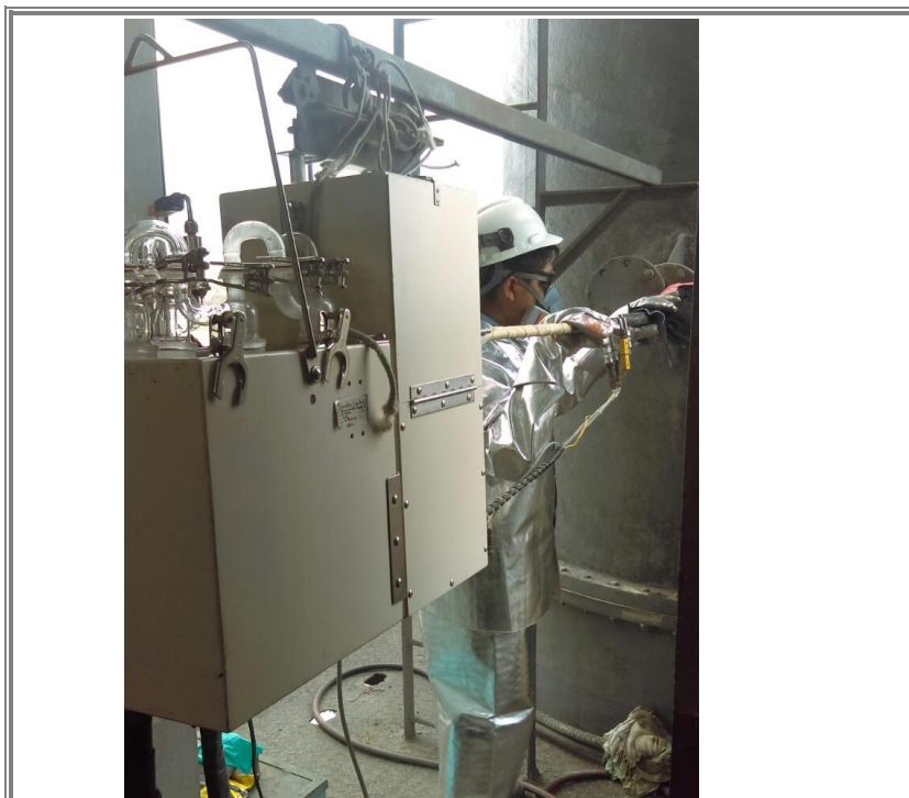
FOTO 06. EQUIPO MUESTREADOR ISOCINETICO EN PLENA SUCCIÓN DE GASES Y CAPTURA DEL MATERIAL PARTICULADO CON EL ANALISTA DE CAMPO
