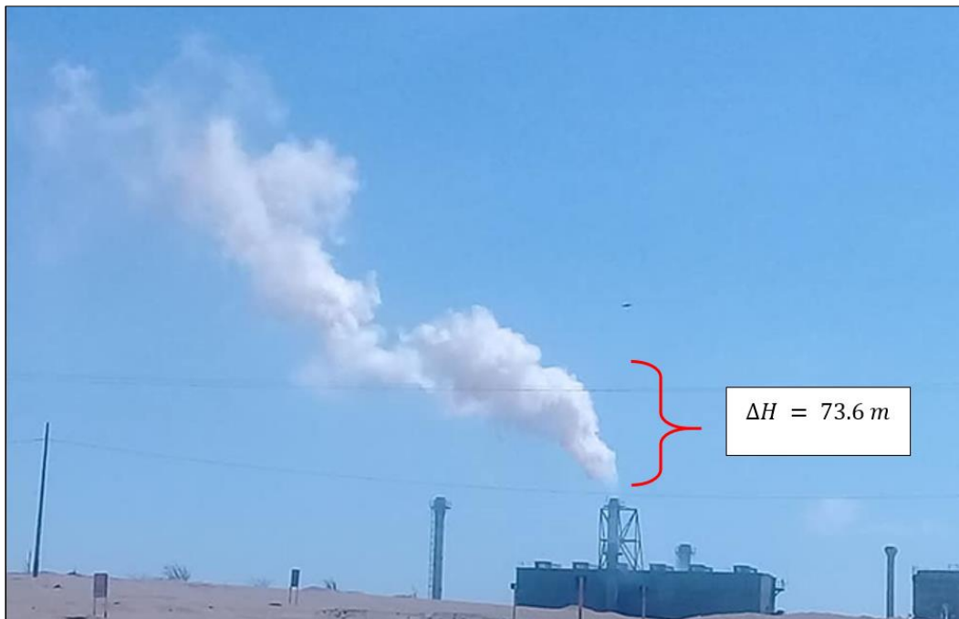
Figura 19. Penacho de humos de la Chimenea de Fundición, medición del \Delta H
