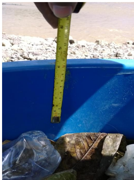
Figura 34. Medición de la altura libre del cilindro.
